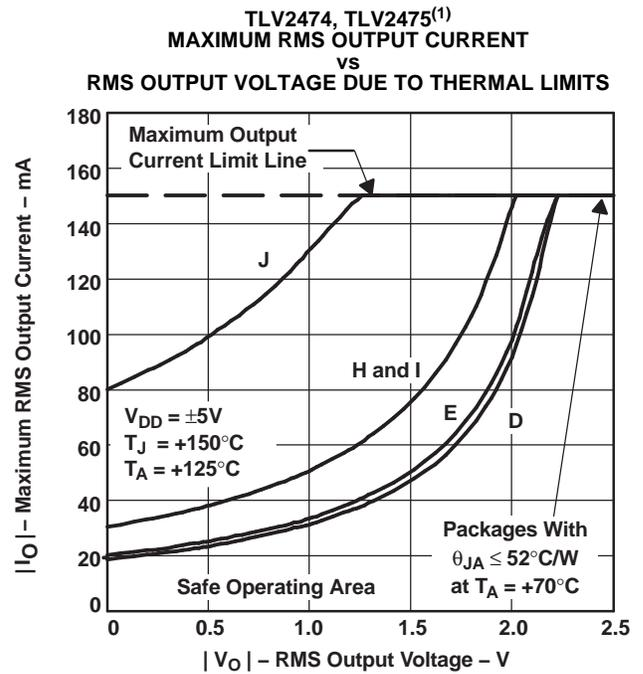
NOTE: (1) A - SOT23 (5); B - SOT23 (6); C - SOIC (8); D - SOIC (14); E - SOIC (16); F - MSOP PP (8); G - PDIP (8); H - PDIP (14); I - PDIP (16); J - TSSOP PP (14/16)
