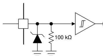
Figure 8-9. Logic-level input
