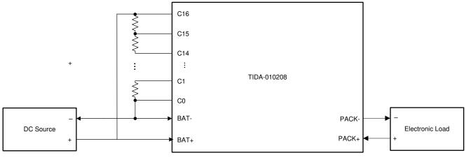
Figure 3-2. Discharge Setup
