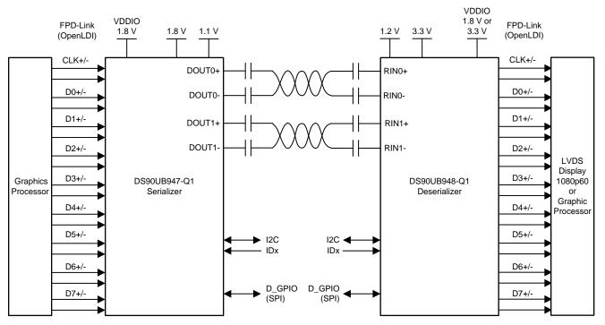
Figure 5. DS90UB947-Q1, DS90UB948-Q1 Typical Application
