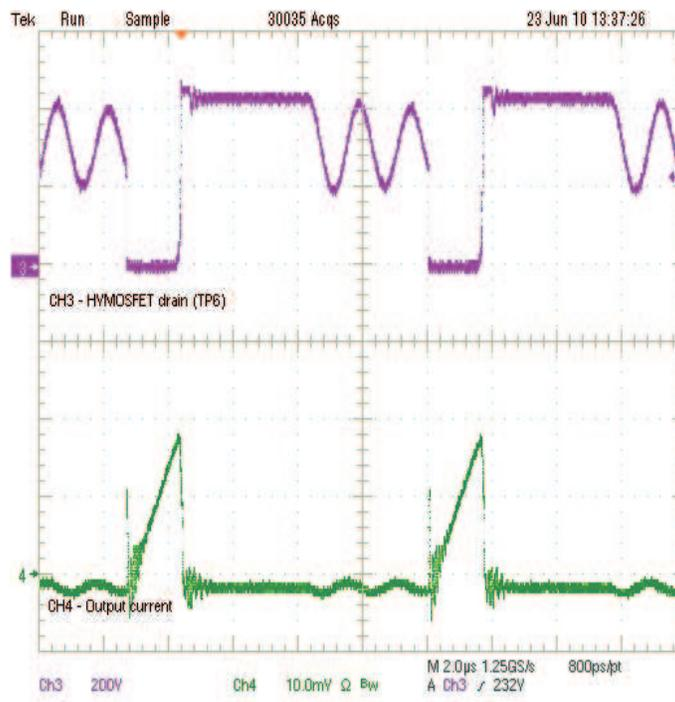
Figure 11. Switching-Node Waveform (CH4 – 200 mA/10 mV)
