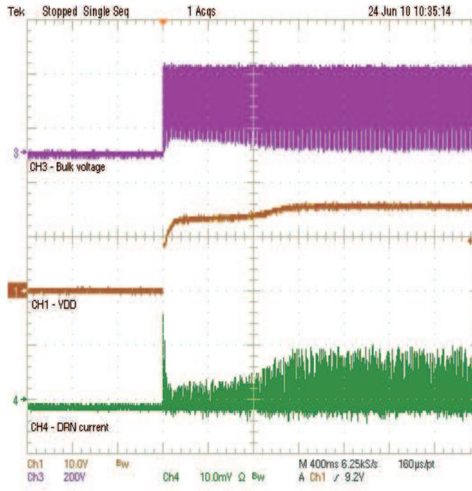
Figure 12. Turn-On Waveform (CH4 – 500 mA/10 mV)
