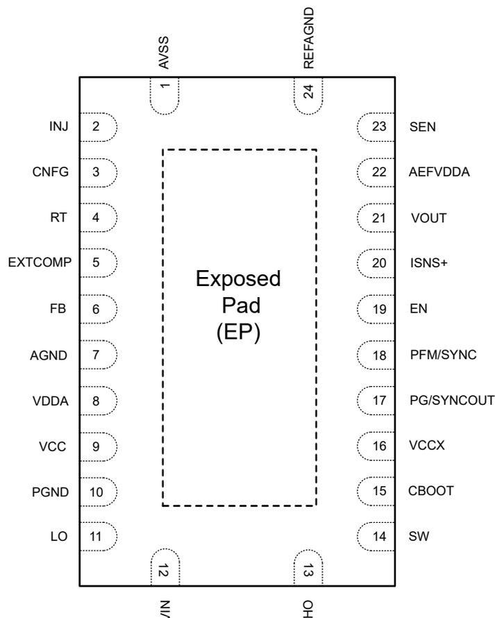
**Figure 4-1. Pin Diagram**
