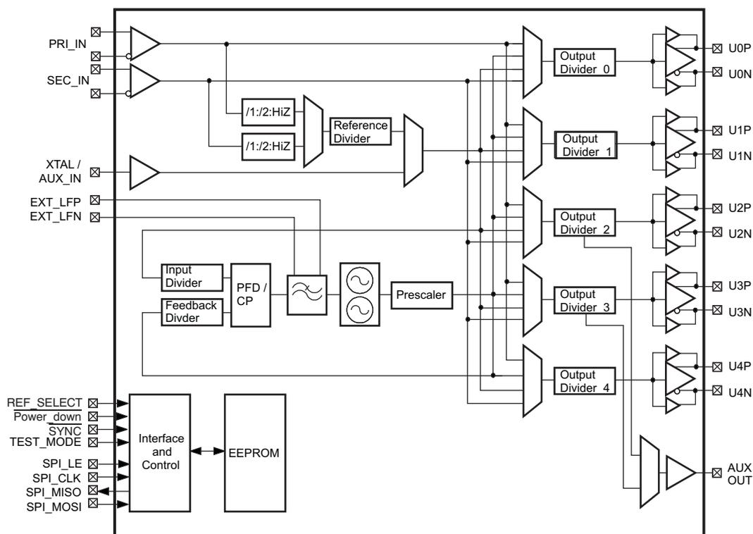
Figure 1. CDCE62005 Block Diagram
