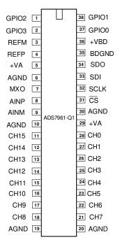
Figure 4-1. Pin Diagram
