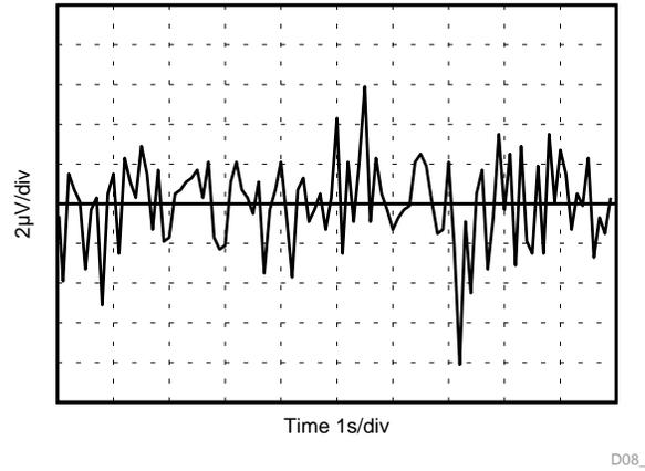
**Figure 26. 0.1-Hz to 10-Hz Noise ( $V_{REF}$ )**
