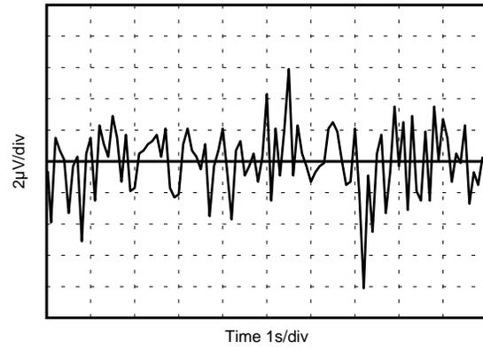
**Figure 20. 0.1-Hz to 10-Hz Noise ( $V_{REF}$ )**
