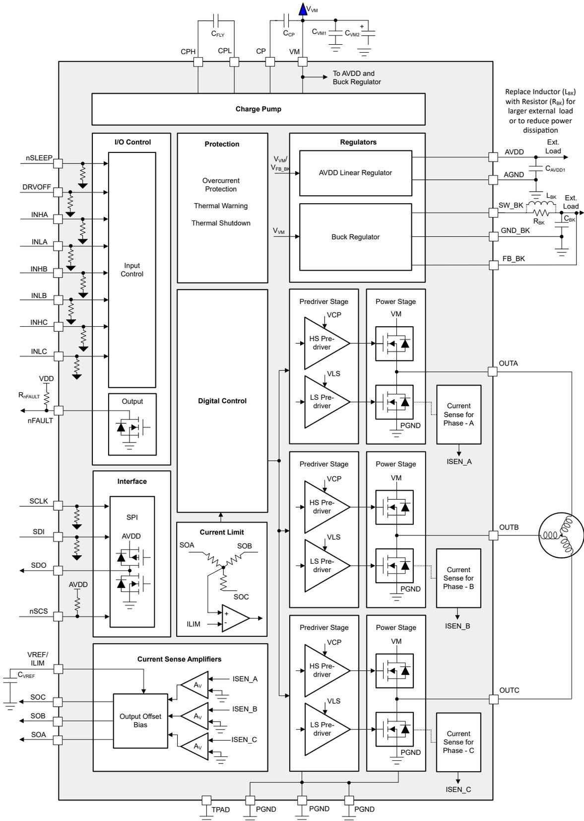
Figure 8-1. DRV8316R-Q1 Block Diagram
