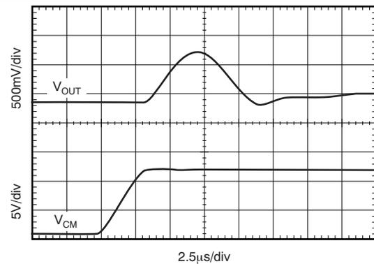
**Figure 24. 12-V Common-Mode Step Response**
