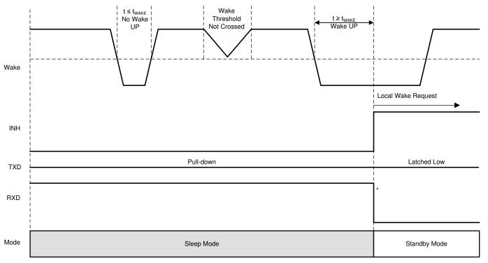
Figure 9-6. Local Wake-Up - Falling Edge
