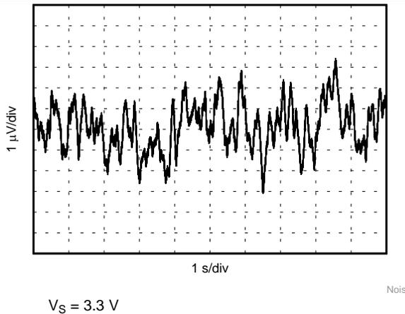
Figure 27. 0.1-Hz to 10-Hz Noise,  $V_S = 3.3\text{ V}$
