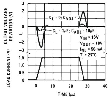
Figure 6-6. Load Transient Response (New Chip)
