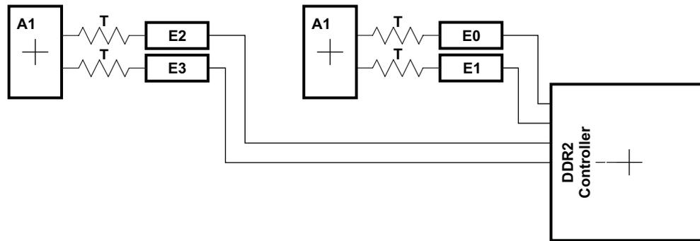
Figure 8-54. DQS and DQ Routing and Topology
