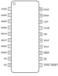
Figure 4-1. Pin Diagram
