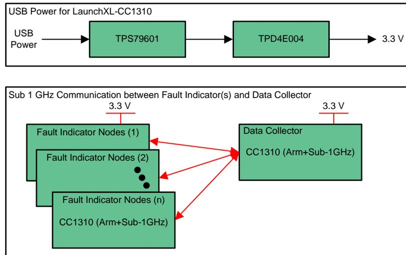
図 1. TIDA-00816 Block Diagram
