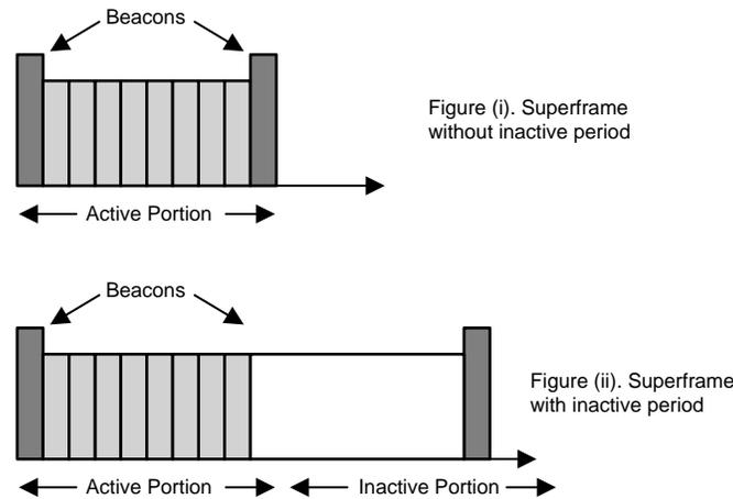
図 5. Beacon Frame Structure
