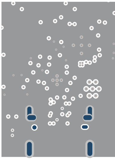
図 7-9. TPS26750 PCB Layout - GND Layer 5
