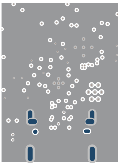
図 7-6. TPS26750 PCB Layout - GND Layer 2
