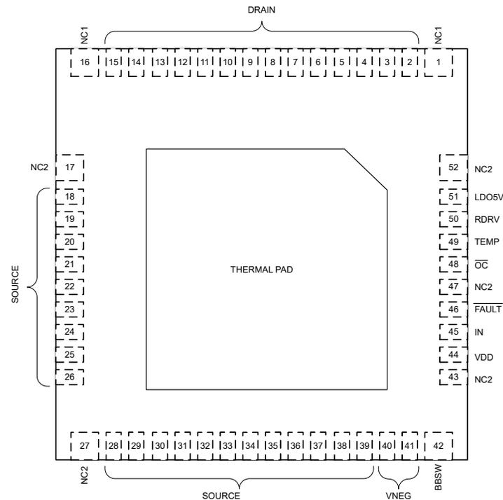
図 4-1. RQS Package, 52-Pin VQFN (Top View)
