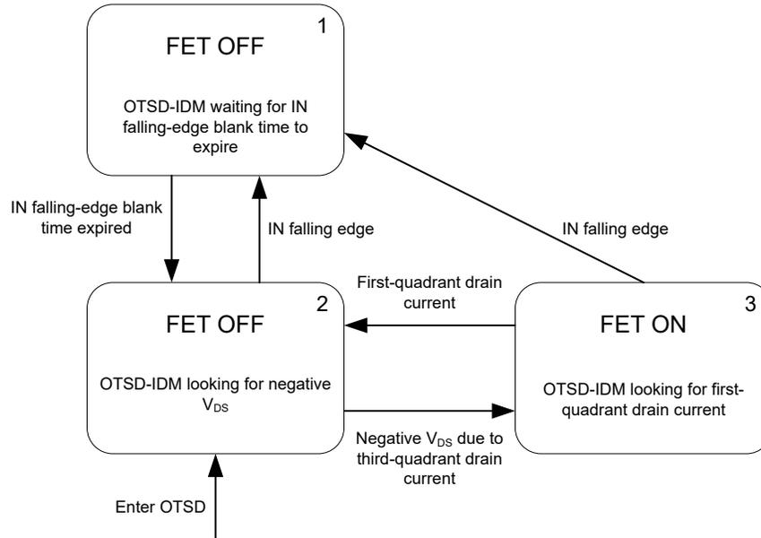
**图 7-6. Overtemperature-Shutdown Ideal-Diode Mode (OTSD-IDM) State Machine**
