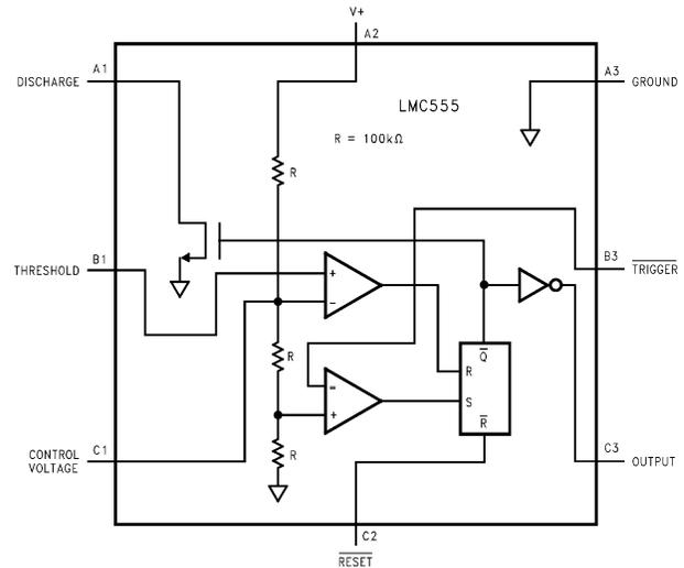
図 4-2. YPB パッケージ、8 ピン DSBGA (上面図)
