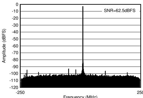
2.6GHz 整合あり、 $f_{\text{IN}} = 2610\text{MHz}$ 、 $A_{\text{IN}} = -3\text{dBFS}$
