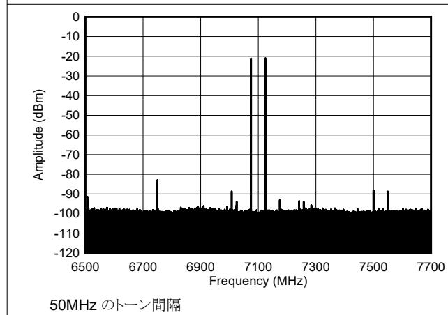
図 4-586. 7.1GHz、-13dBFS での 2 トーン出力スペクトル (ナロースパン)
