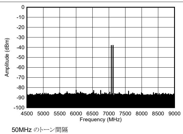
図 4-587. 7.1GHz、-30dBFS での 2 トーン出力スペクトル (ナイキスト)
