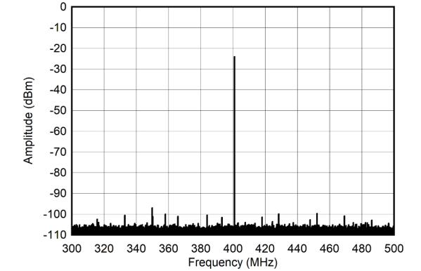
図 4-276. 400MHz、-30dBFS でのシングルトーンスペクトル (-±100MHz)
