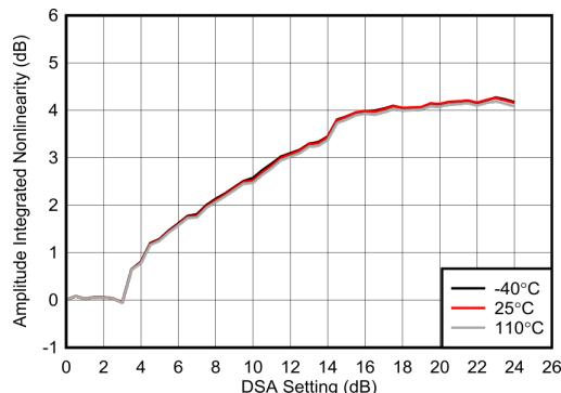
図 4-205. 6.851 GHz での RX 未較正積分振幅誤差
