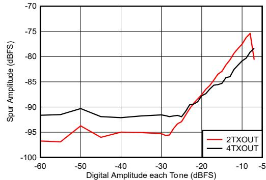
帯域内 =  $3.75\text{GHz} \pm 600\text{MHz}$ 、 $f_{\text{DAC}} = 9\text{ GSPS}$ 、外部クロックモード、非インターリープモード。
