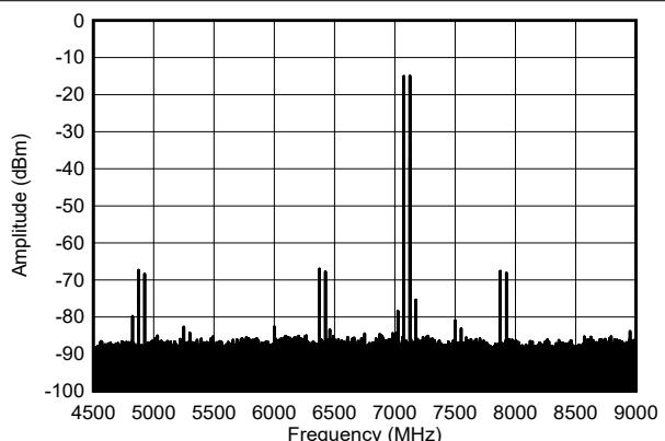
図 4-583. 7.1GHz、-7dBFS での 2 トーン出力スペクトル (ナイキスト)
