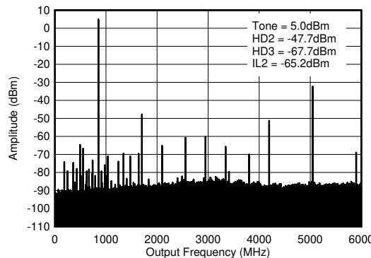
$f_{\text{DAC}} = 5898.24\text{MSPS}$ 、インターリープモード、0.8GHz 整合あり、PCB とケーブルの損失を含む。ILn =  $f_{\text{S}}/n \pm f_{\text{OUT}}$ 。
