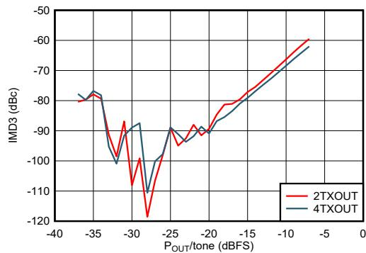
$f_{\text{DAC}} = 8847.36\text{MSPS}$ 、ストレート モード、 $f_{\text{CENTER}} = 2.6\text{GHz}$ 、
