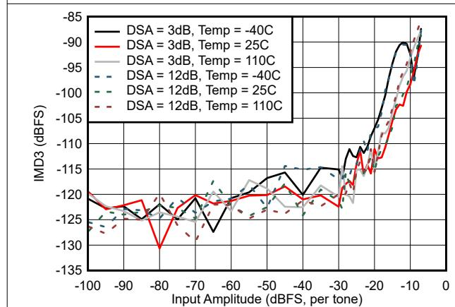
$f_{\text{ADC}} = 1500\text{MSPS}$ 、 $f_{\text{NCO}} = 32.13\text{MHz}$ 、24x によってデシメーション
