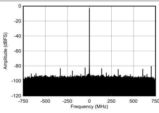
図 4-211. 6.851GHz、-3 dBFS での RX 出力 FFT
