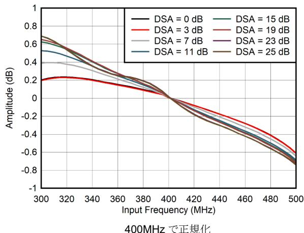
図 4-29. RX 帯域内ゲイン平坦性 ( $f_{\text{IN}} = 400\text{MHz}$ )
