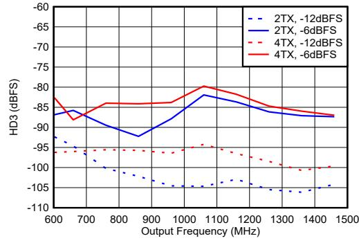
0.8GHz で整合、 $f_{\text{DAC}} = 8847.36\text{MSPS}$ 、ストレート モード、高調波周波数での出力電力で正規化。
