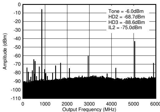
$f_{\text{DAC}} = 5898.24\text{MSPS}$ 、インターリープモード、0.8GHz 整合あり、PCB とケーブルの損失を含む。 $\text{ILn} = f_s/n \pm f_{\text{OUT}}$
