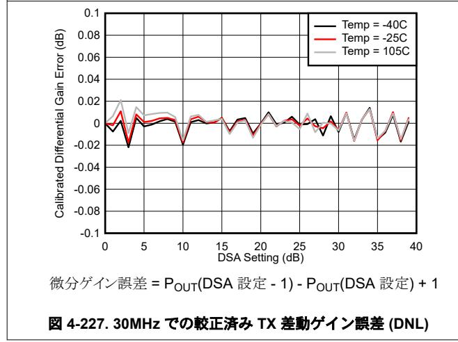
図 4-227. 30MHz での較正済み TX 差動ゲイン誤差 (DNL)
