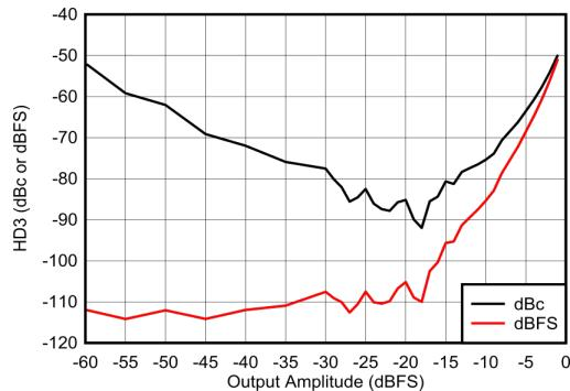
図 4-292. 400MHz での HD3 と振幅との関係
