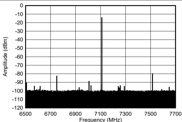
図 4-580. 7.1GHz、-6dBFS でのシングル トーン出力スペクトル (狭いスパン)
