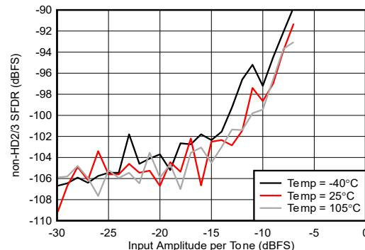
図 4-221. 6.85 GHz での RX 2 トーン SFDR と入力振幅との関係
