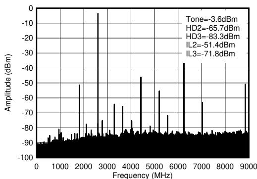
$f_{\text{DAC}} = 8847.36\text{MSPS}$ 、インターリープ モード、2.6GHz 整合あり、PCB とケーブルの損失を含む。 $\text{IL}_n = f_s/n \pm f_{\text{OUT}}$ 。
