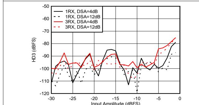
1.8GHz 整合あり、 $f_{\text{in}} = 1900\text{MHz}$ 、DDC バイパス モード (特性評価用 テキサス・インスツルメンツ専用モード)
