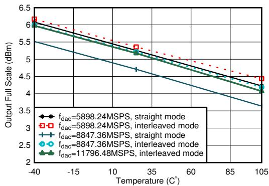
PCB とケーブルの損失を含む。 $A_{\text{out}} = -0.5\text{dBFS}$ 、DSA = 0、0.8GHz 整合あり
