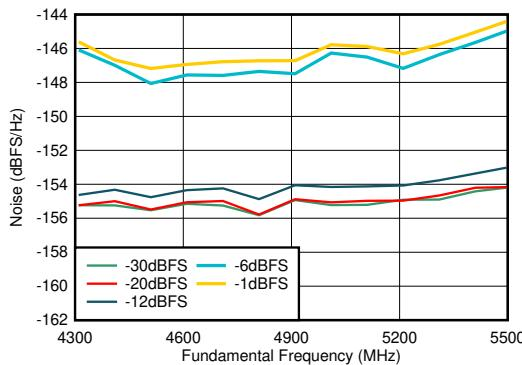
$f_{\text{DAC}} = 11796.48\text{MSPS}$ 、インターリープモード、4.9GHz で整合、 $A_{\text{out}} = -13\text{dBFS}$ 。
