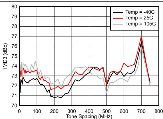
図 4-570. 7.1GHz での IMD3 とトーン間隔と温度との関係
