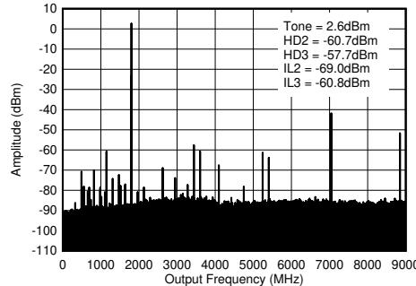
$f_{\text{DAC}} = 8847.36\text{ MSPS}$ 、ストレートモード、1.8GHz 整合あり、PCB とケーブルの損失を含む。IL<sub>n</sub> =  $f_{\text{S}}/n \pm f_{\text{OUT}}$  (デジタルクロックとのミキシングに起因)。
