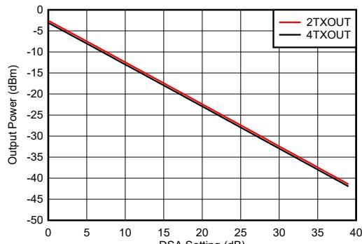
$f_{\text{DAC}} = 11796.48\text{ MSPS}$ 、 $A_{\text{out}} = -0.5\text{ dBFS}$ 、4.9 GHz 整合あり
