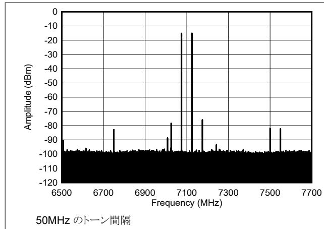
図 4-584. 7.1GHz、-7dBFS での 2 トーン出力スペクトル (ナローバンド)
