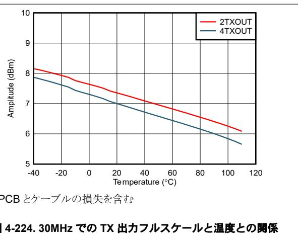
図 4-224. 30MHz での TX 出力フルスケールと温度との関係
