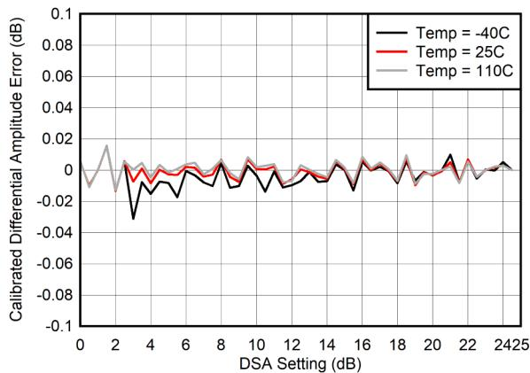
図 4-31. RX 較正済み微分振幅誤差と DSA 設定との関係 (400MHz)
