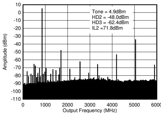
$f_{\text{DAC}} = 5898.24\text{MSPS}$ 、ストレートモード、0.8GHz 整合あり、PCB とケーブルの損失を含む。 $\text{ILn} = f_{\text{S}}/n \pm f_{\text{OUT}}$  (デジタルクロックとのミキシングに起因)。
