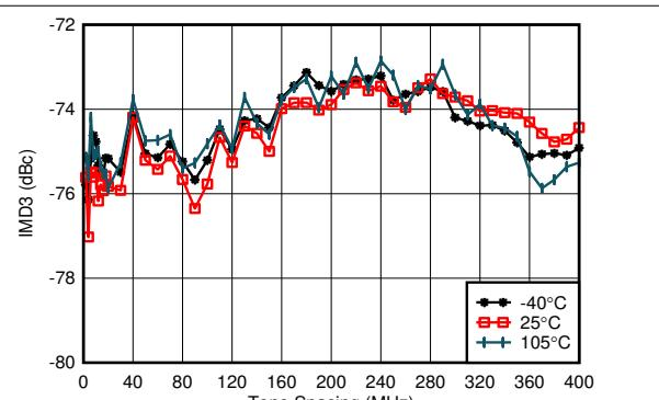
$f_{\text{DAC}} = 11796.48\text{MSPS}$ 、インターリープモード、4.9GHz で整合、 $f_{\text{CENTER}} = 4.9\text{GHz}$ 、各トーン -13dBFS、ワーストチャネル
