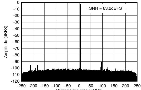
0.8GHz 整合あり、 $f_{\text{IN}} = 840\text{MHz}$ 、 $A_{\text{IN}} = -3\text{dBFS}$
