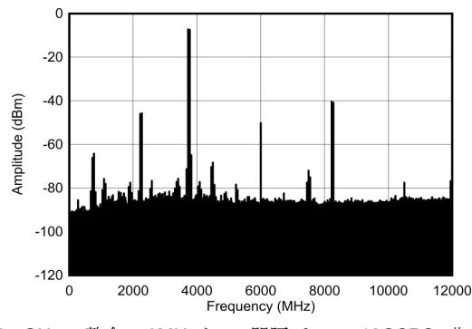
3.5GHz で整合、50MHz トーン間隔、 $f_{\text{DAC}} = 12\text{GSPS}$ 、非インターリープ モード。
