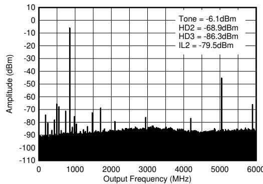
$f_{\text{DAC}} = 5898.24\text{MSPS}$ 、ストレートモード、0.8GHz 整合あり、PCB とケーブルの損失を含む。ILn =  $f_{\text{S}}/n \pm f_{\text{OUT}}$  (デジタルクロックとのミキシングに起因)。
