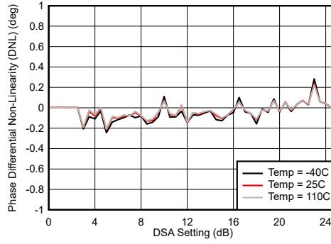
微分位相誤差 =  $\text{Phase}_{\text{IN}}(\text{DSA 設定} - 1) - \text{Phase}_{\text{IN}}(\text{DSA 設定})$
