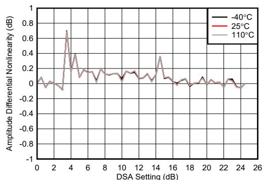
図 4-203. 6.851 GHz での RX 未較正微分振幅誤差
