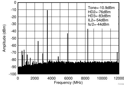
3.5GHz で整合、 $f_{\text{DAC}} = 11.79648\text{GSPS}$ 、インターリープ モード。
