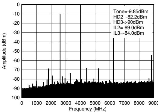
$f_{\text{DAC}} = 8847.36\text{MSPS}$ 、ストレート モード、2.6GHz 整合あり、PCB とケーブルの損失を含む。 $\text{ILn} = f_{\text{S}}/n \pm f_{\text{OUT}}$  (デジタル クロックとのミキシングに起因)。
