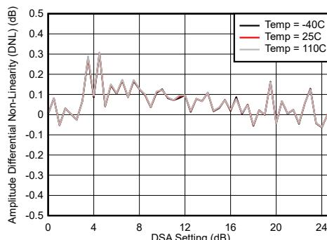
微分振幅誤差 =  $P_{\text{IN}}(\text{DSA 設定} - 1) - P_{\text{IN}}(\text{DSA 設定}) + 1$
