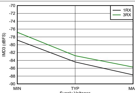
3.6GHz 整合あり、各トーン -7dBFS、20MHz のトーン間隔、すべての電源電圧は推奨動作条件の最小値、代表値、最大値
