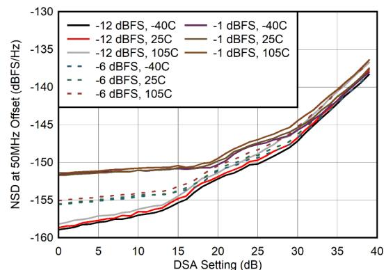
図 4-288. 400MHz でのノイズ スペクトル密度と DSA 設定の関係
