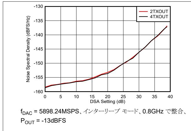
図 4-317. TX 出力ノイズと減衰量との関係 (各種チャネル、0.85GHz)
