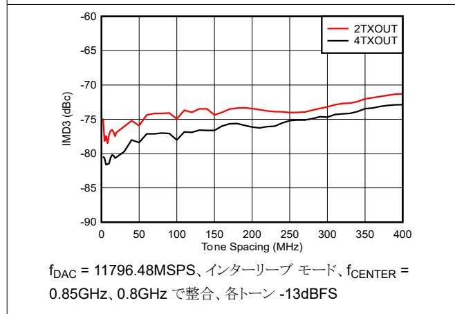
図 4-321. TX IMD3 とトーン間隔との関係 (各種チャネル、0.85GHz)
