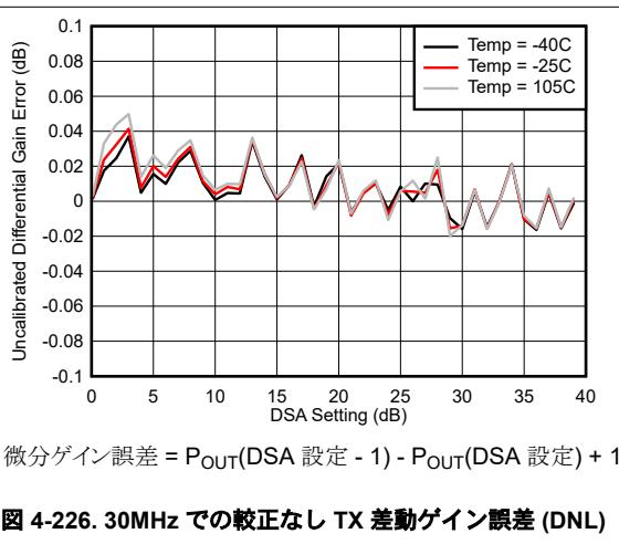
図 4-226. 30MHz での較正なし TX 差動ゲイン誤差 (DNL)
