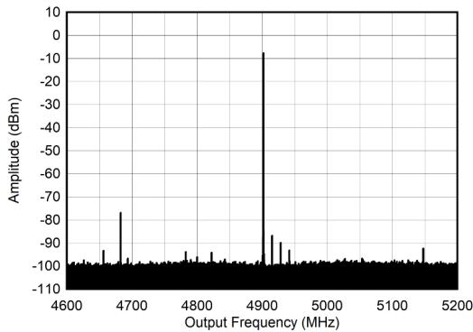
$f_{\text{DAC}} = 11796.48\text{MSPS}$ 、インターリープモード、4.9GHz 整合あり、PCB とケーブルの損失を含む
