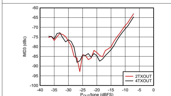
$f_{\text{DAC}} = 11796.48\text{MSPS}$ 、インターリープモード、4.9GHz で整合、 $f_{\text{CENTER}} = 4.9\text{GHz}$ 、 $f_{\text{SPACING}} = 20\text{MHz}$
