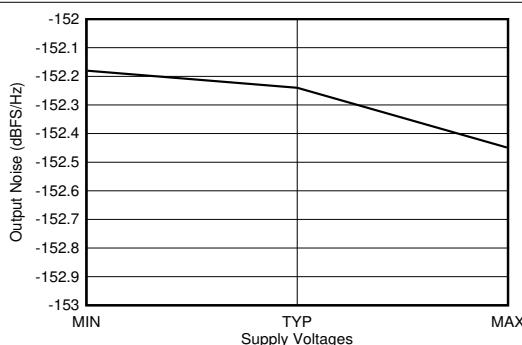
$f_{\text{DAC}} = 11796.48\text{MSPS}$ 、インターリープ モード、2.6GHz 整合あり。トーンから 40MHz オフセット。出力電力 = -1dBFS。すべての電源電圧に最小値、代表値、最大値がある。
