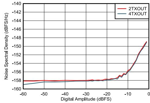
$f_{\text{DAC}} = 9000\text{MSPS}$ 、非インターリープモード、外部クロックモード、50MHz オフセット
