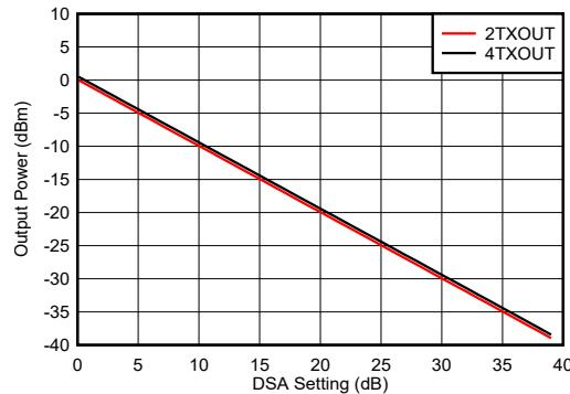
$A_{\text{out}} = -0.5\text{dBFS}$ 、3.5GHz 整合あり、PCB とケーブルの損失を含む。
