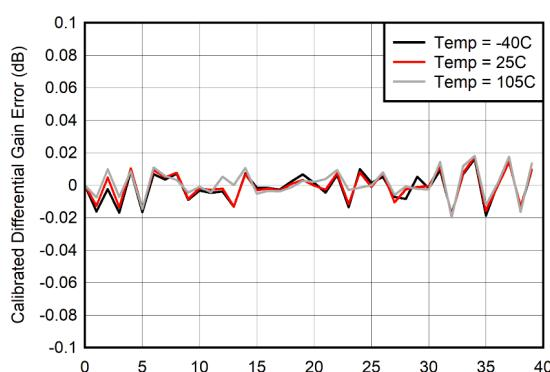
微分ゲイン誤差 =  $P_{\text{OUT}}(\text{DSA 設定} - 1) - P_{\text{OUT}}(\text{DSA 設定}) + 1$
