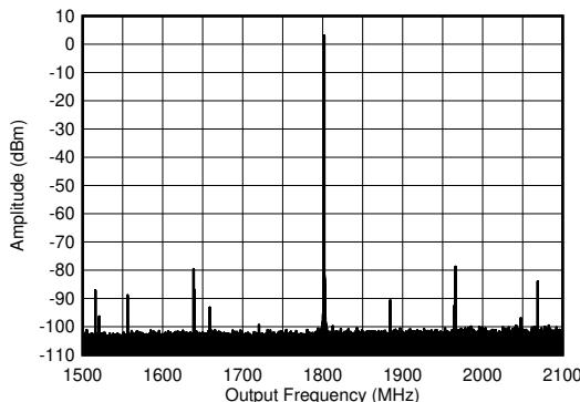
$f_{\text{DAC}} = 8847.36\text{MSPS}$ 、インターリープモード、1.8GHz 整合あり、PCB とケーブルの損失を含む
