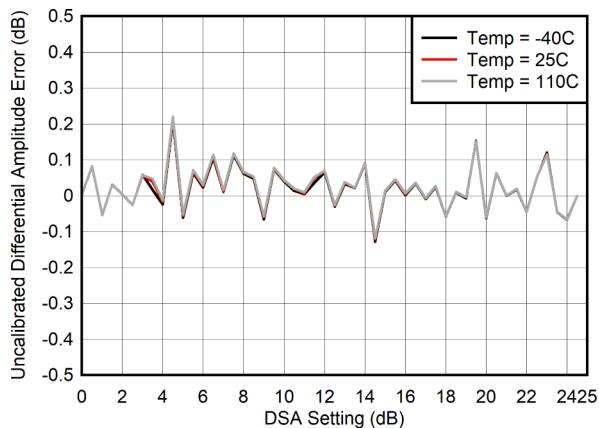
図 4-30. RX 未較正微分振幅誤差と DSA 設定との関係 (30MHz)
