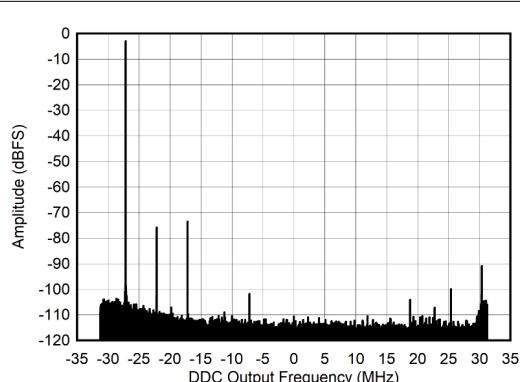
$A_{\text{IN}} = -3\text{dBFS}$ 、 $f_{\text{ADC}} = 1500\text{MSPS}$ 、 $f_{\text{NCO}} = 32.13\text{MHz}$ 、24x でデシメーション
