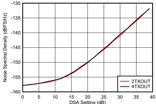
A.  $f_{\text{DAC}} = 11796.48\text{MSPS}$ 、インターリープモード、3.5GHz で整合、 $A_{\text{out}} = -13\text{dBFS}$ 。
