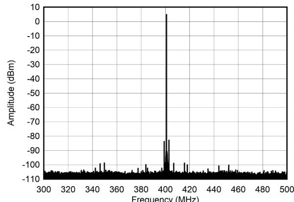
図 4-270. 400MHz、-1dBFS でのシングル トーン スペクトル (-±100MHz)
