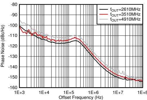
PLL イネーブル、 $f_{VCO} = 9830.4\text{MHz}$ 、 $f_{\text{REF}} = 491.52\text{MSPS}$ 、2TXOUT で測定
