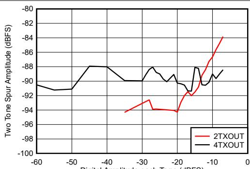
帯域内 = 2600MHz  $\pm$  600MHz、 $f_{\text{DAC}} = 12\text{GSPS}$ 、 $F_s/3$  および  $F_s/4$  を含まず、外部クロック モード、非インターリープ モード
