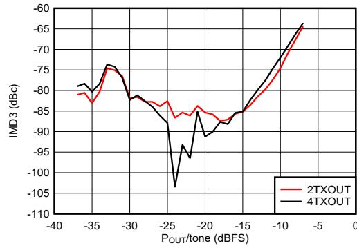
$f_{\text{DAC}} = 11796.48\text{MSPS}$ 、インターリープモード、 $f_{\text{CENTER}} = 0.85\text{GHz}$ 、 $f_{\text{SPACING}} = 20\text{MHz}$ 、 $0.8\text{GHz}$  で整合
