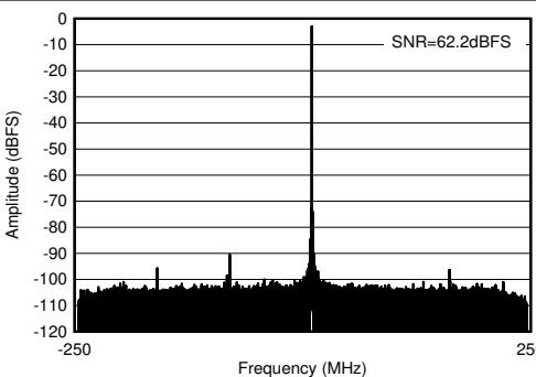
3.6GHz 整合あり、 $f_{\text{IN}} = 3610\text{MHz}$ 、 $A_{\text{IN}} = -3\text{dBFS}$
