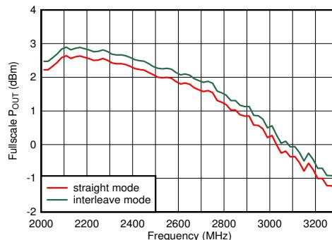
PCB とケーブルの損失を含む。 $A_{\text{OUT}} = -0.5\text{dBFS}$ 、DSA = 0、2.6GHz 整合あり
