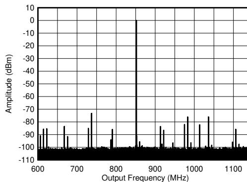
$f_{\text{DAC}} = 5898.24\text{MSPS}$ 、インターリープモード、0.8GHz 整合あり、PCB とケーブルの損失を含む
