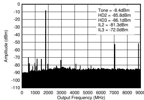
$f_{\text{DAC}} = 8847.36\text{MSPS}$ 、ストレートモード、1.8GHz 整合あり、PCB とケーブルの損失を含む。IL<sub>n</sub> =  $f_{\text{S}/\text{h}} \pm f_{\text{OUT}}$  (デジタルクロックとのミキシングに起因)。
