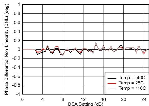
微分位相誤差 =  $\text{Phase}_{\text{IN}}(\text{DSA 設定} - 1) - \text{Phase}_{\text{IN}}(\text{DSA 設定})$
