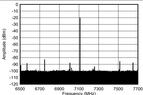
図 4-582. 7.1GHz、-12dBFS でのシングル トーン出力スペクトル (狭いスパン)
