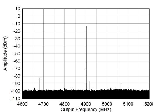
$f_{\text{DAC}} = 11796.48\text{MSPS}$ 、インターリープモード、4.9GHz 整合あり、PCB とケーブルの損失を含む
