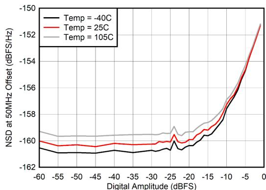
図 4-287. 400MHz でのノイズ スペクトル密度とデジタル振幅
