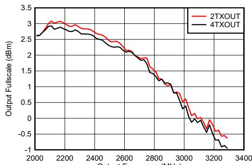
$f_{\text{DAC}} = 8847.36\text{MSPS}$ 、インターリーブモード、PCB およびケーブルの損失を含む、 $A_{\text{OUT}} = -0.5\text{dBFS}$ 、DSA = 0、2.6GHz 整合あり
