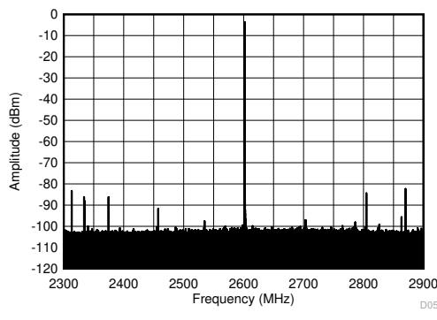
$f_{\text{DAC}} = 8847.36\text{MSPS}$ 、インターリープ モード、2.6GHz 整合あり、PCB とケーブルの損失を含む
