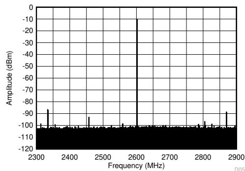
$f_{\text{DAC}} = 8847.36\text{MSPS}$ 、ストレート モード、2.6GHz 整合あり、PCB とケーブルの損失を含む
