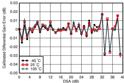
$f_{\text{DAC}} = 8847.36\text{MSPS}$ 、ストレートモード、2.6GHz で整合、全 DSA 設定にわたって 25°Cでの誤差が中央値であるチャネル
