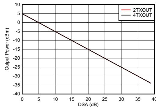
$f_{\text{DAC}} = 11796.48\text{MSPS}$ 、インターリープモード、 $A_{\text{OUT}} = -0.5\text{dBFS}$ 、0.8GHz に整合
