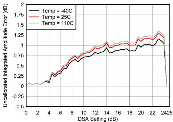
図 4-32. RX 未較正積分振幅誤差と DSA 設定との関係 (400MHz)
