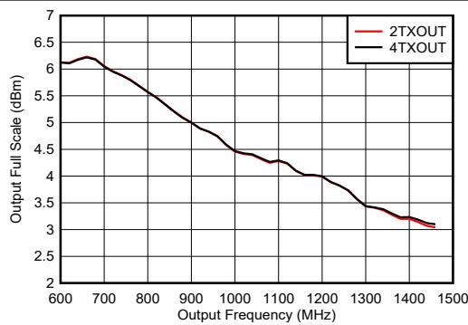
PCB とケーブルの損失を含む。 $A_{\text{out}} = -0.5\text{ dBFS}$ 、DSA = 0、
