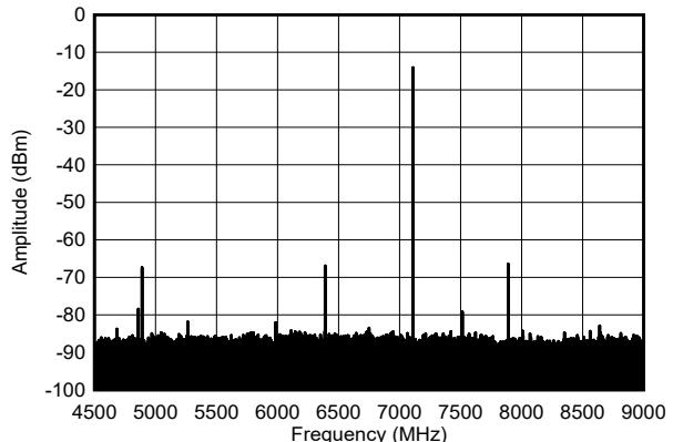
図 4-579. 7.1GHz、シングル トーン出力スペクトル、-6dBFS (ナイキスト)
