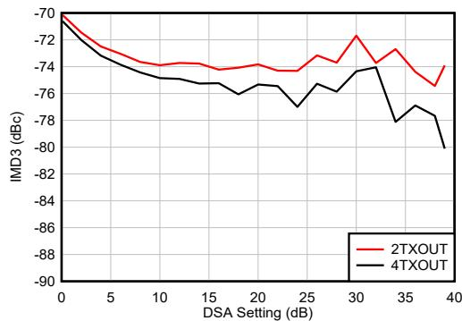
20MHz のトーン間隔、3.5GHz 整合あり、各トーン -13dBFS、PCB とケーブルの損失を含む。
