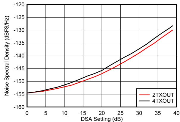
$f_{\text{DAC}} = 11796.48\text{MSPS}$ 、インターリープモード、4.9GHz で整合、 $P_{\text{OUT}} = -13\text{dBFS}$
