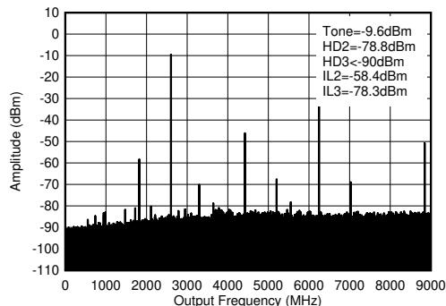
$f_{\text{DAC}} = 8847.36\text{MSPS}$ 、インターリープ モード、2.6GHz 整合あり、PCB とケーブルの損失を含む。 $\text{IL}_n = f_s/n \pm f_{\text{OUT}}$ 。
