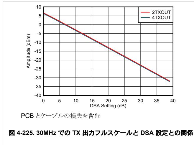
図 4-225. 30MHz での TX 出力フルスケールと DSA 設定との関係
