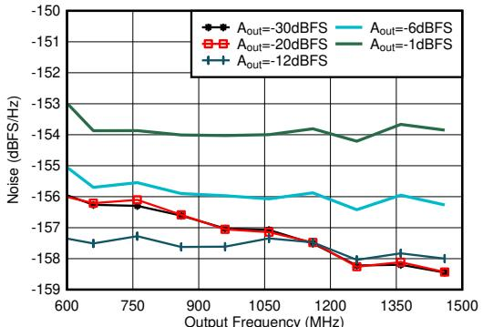
$0.8\text{GHz}$  で整合、シングルトーン、 $f_{\text{DAC}} = 11.79648\text{GSPS}$ 、インターリープモード、 $40\text{MHz}$  オフセット、DSA = 0dB
