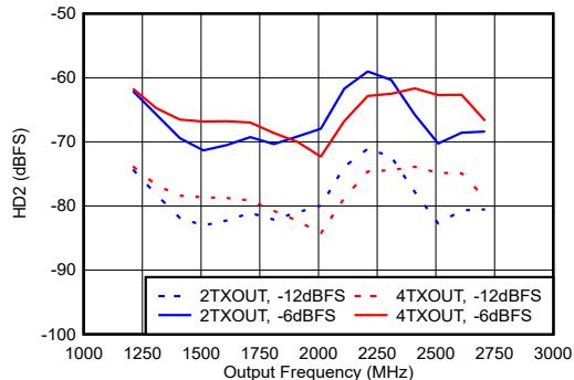
1.8GHz で整合、 $f_{\text{DAC}} = 11.79648\text{GSPS}$ 、インターリープ モード、高調波周波数での出力電力で正規化
