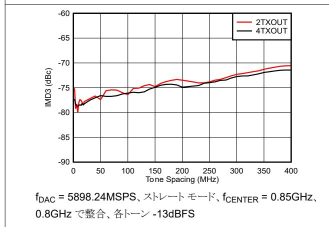
図 4-319. TX IMD3 とトーン間隔との関係 (各種チャネル、0.85GHz)
