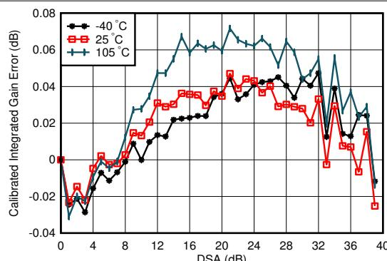
$f_{\text{DAC}} = 11796.48\text{MSPS}$ 、インターリープモード、4.9GHz で整合
