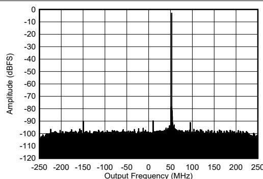
図 4-212. 6.851GHz、-6dBFS での RX 出力 FFT
