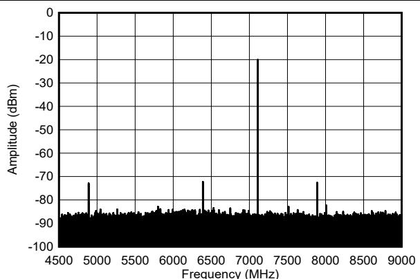
図 4-581. 7.1GHz、シングル トーン出力スペクトル、-12dBFS (ナイキスト)
