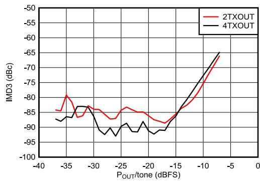
$f_{\text{DAC}} = 8847.36\text{MSPS}$ 、ストレートモード、 $f_{\text{CENTER}} = 0.85\text{GHz}$ 、 $f_{\text{SPACING}} = 20\text{MHz}$ 、 $0.8\text{GHz}$  で整合
