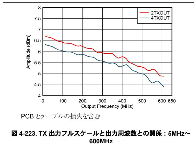
図 4-223. TX 出力フルスケールと出力周波数との関係 : 5MHz~600MHz
