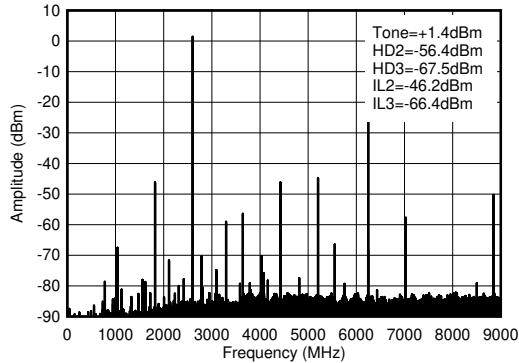
$f_{\text{DAC}} = 8847.36\text{MSPS}$ 、インターリープ モード、2.6GHz 整合あり、PCB とケーブルの損失を含む。 $\text{ILn} = f_{\text{S}}/n \pm f_{\text{OUT}}$
