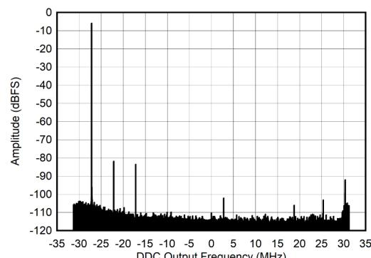
$A_{\text{IN}} = -6\text{dBFS}$ 、 $f_{\text{ADC}} = 1500\text{MSPS}$ 、 $f_{\text{NCO}} = 32$ 。24x でデシメーション
