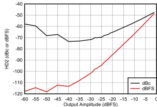
図 4-291. 400MHz での HD2 と振幅との関係
