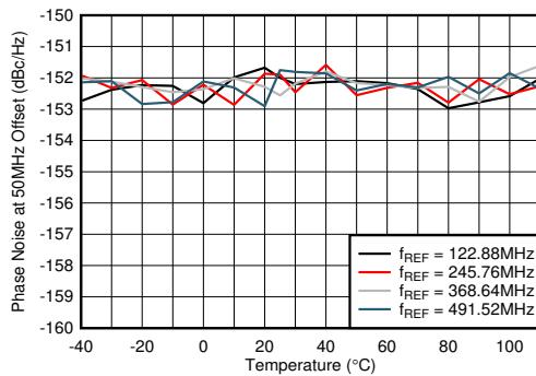
PLL イネーブル、 $f_{VCO} = 11796.48\text{MHz}$ 、2TXOUT で測定
