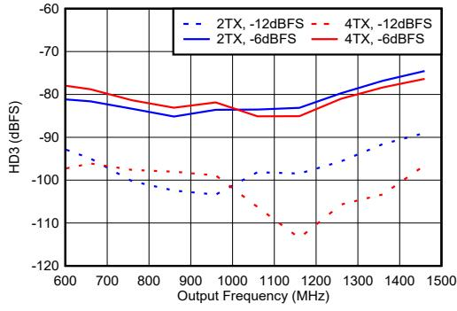
0.8GHz で整合、 $f_{\text{DAC}} = 5898.24\text{MSPS}$ 、ストレート モード、高調波周波数での出力電力で正規化。
