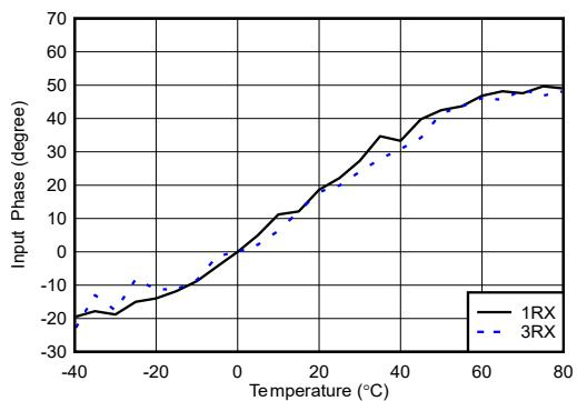
4.9GHz 整合あり、 $25^\circ\text{C}$  の位相で正規化
