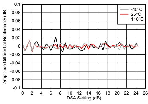
図 4-204. 6.851 GHz での RX 較正済み微分振幅誤差
