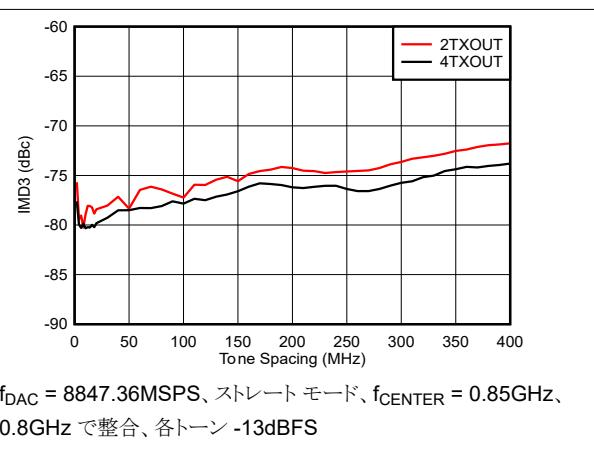
図 4-320. TX IMD3 とトーン間隔との関係 (各種チャネル、0.85GHz)
