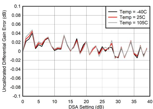
微分ゲイン誤差 =  $P_{\text{OUT}}(\text{DSA 設定} - 1) - P_{\text{OUT}}(\text{DSA 設定}) + 1$
