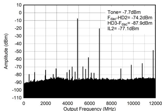
$f_{\text{DAC}} = 11796.48\text{MSPS}$ 、インターリープモード、4.9GHz 整合あり、PCB とケーブルの損失を含む。 $\text{ILn} = f_{\text{S}}/n \pm f_{\text{OUT}}$
