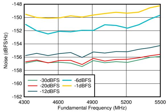
$f_{\text{DAC}} = 11796.48\text{MSPS}$ 、インターリープモード、4.9GHz で整合、 $A_{\text{out}} = -13\text{dBFS}$ 。
