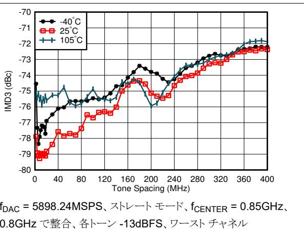
図 4-322. TX IMD3 とトーン間隔との関係 (各種温度、0.85GHz)
