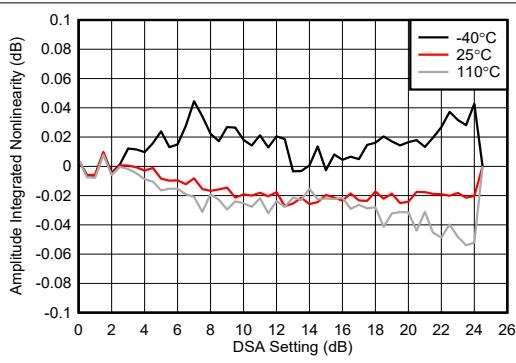
図 4-206. 6.851 GHz での RX 較正済み積分振幅誤差
