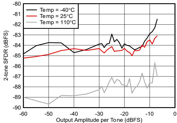
50MHz トーン間隔、帯域内 = 7100MHz  $\pm$  200MHz。IMD3 成分を個別に除く
