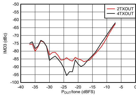
$f_{\text{DAC}} = 5898.24\text{MSPS}$ 、ストレートモード、 $f_{\text{CENTER}} = 0.85\text{GHz}$ 、 $f_{\text{SPACING}} = 20\text{MHz}$ 、 $0.8\text{GHz}$  で整合
