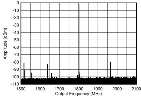
$f_{\text{DAC}} = 8847.36\text{ MSPS}$ 、ストレートモード、1.8GHz 整合あり、PCB とケーブルの損失を含む
