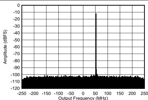
図 4-213. 6.851GHz、-12 dBFS での RX 出力 FFT
