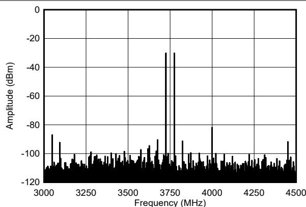
3.5GHz で整合、50 MHz トーン間隔、 $f_{\text{DAC}} = 12\text{GSPS}$ 、非インターリープモード。
