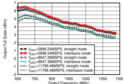
PCB とケーブルの損失を含む。 $A_{\text{out}} = -0.5\text{dBFS}$ 、DSA = 0、0.8GHz 整合あり
