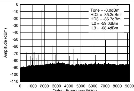
$f_{\text{DAC}} = 8847.36\text{MSPS}$ 、インターリープ モード、1.8GHz 整合あり、PCB とケーブルの損失を含む。 $IL_n = f_{\text{S/N}} \pm f_{\text{OUT}}$ 。
