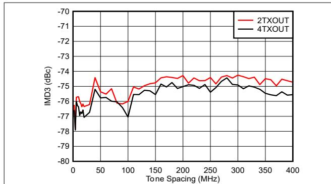
$f_{\text{DAC}} = 11796.48\text{MSPS}$ 、インターリープモード、4.9GHz で整合、 $f_{\text{CENTER}} = 4.9\text{GHz}$ 、各トーン -13dBFS
