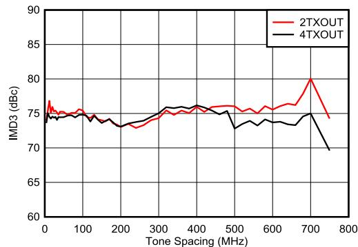
図 4-568. 7.1GHz での IMD3 とトーン間隔とチャネルとの関係
