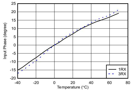
1.8GHz 整合あり、 $25^\circ\text{C}$  の位相で正規化
