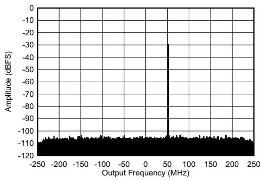
図 4-214. 6.851GHz, -30 dBFS での RX 出力 FFT
