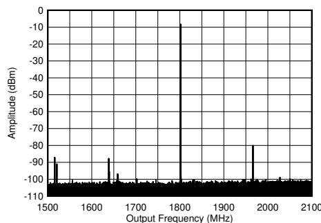
$f_{\text{DAC}} = 8847.36\text{MSPS}$ 、ストレートモード、1.8GHz 整合あり、PCB とケーブルの損失を含む
