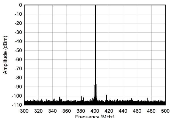
図 4-272. 400MHz、-6dBFS でのシングルトーンスペクトル (-±100MHz)
