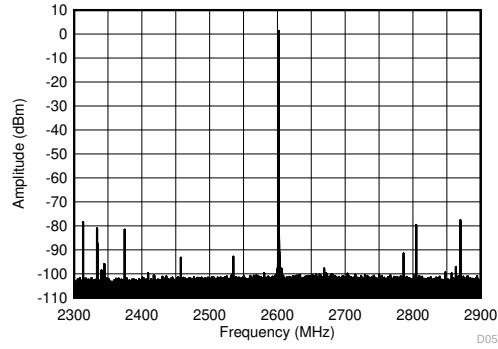
$f_{\text{DAC}} = 8847.36\text{MSPS}$ 、インターリープ モード、2.6GHz 整合あり、PCB とケーブルの損失を含む
