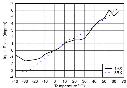
0.8GHz 整合あり、 $25^\circ\text{C}$  の位相で正規化
