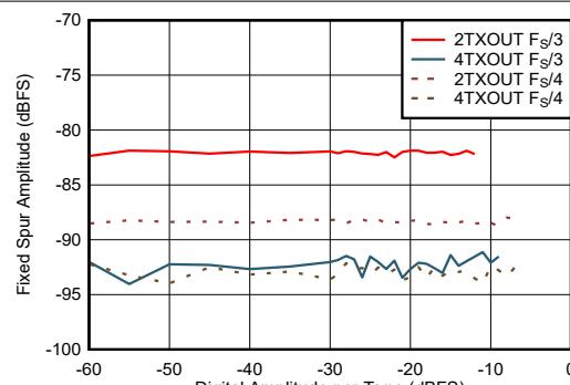
帯域内 = 2600MHz  $\pm$  600MHz、 $f_{\text{DAC}} = 12\text{GSPS}$ 、外部クロック モード、非インターリープ モード
