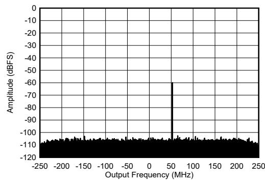
図 4-215. 6.851GHz, -60 dBFS での RX 出力 FFT
