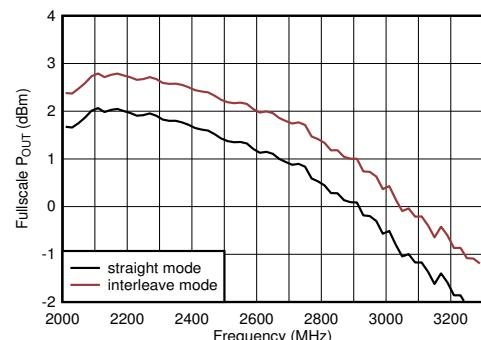
PCB とケーブルの損失を含む。 $A_{\text{OUT}} = -0.5\text{dBFS}$ 、DSA = 0、2.6GHz 整合あり
