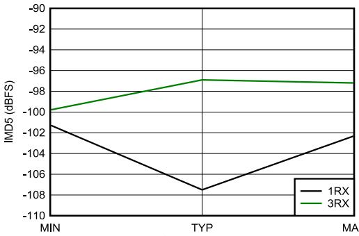
3.6GHz 整合あり、各トーン -7dBFS、20MHz のトーン間隔、すべての電源電圧は推奨動作条件の最小値、代表値、最大値
