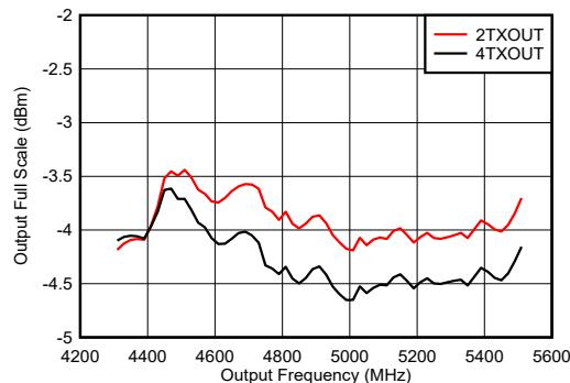
PCB とケーブルの損失を含む。 $A_{\text{out}} = -0.5\text{dBFS}$ 、DSA = 0、4.9 GHz 整合あり
