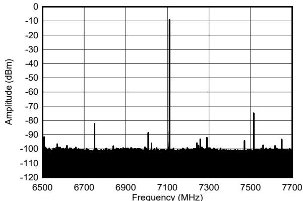
図 4-578. 7.1GHz、-1dBFS でのシングル トーン出力スペクトル (狭いスパン)
