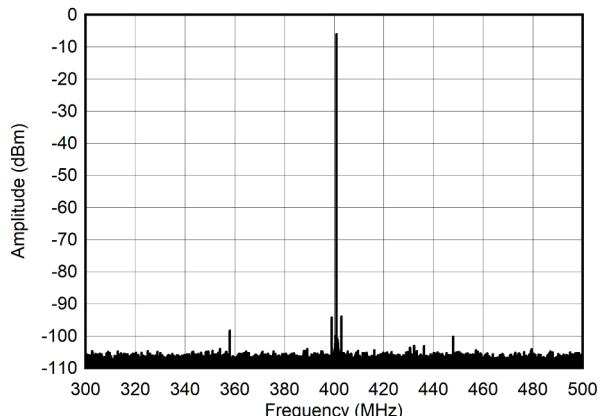
図 4-274. 400MHz、-12dBFS でのシングルトーンスペクトル (-±100MHz)
