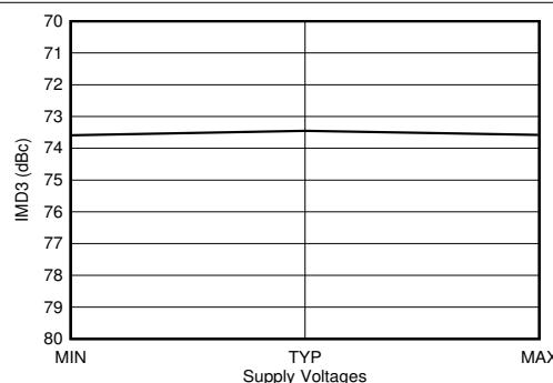
$f_{\text{DAC}} = 11796.48\text{MSPS}$ 、インターリープ モード、2.6GHz 整合あり。トーンから 40MHz オフセット。出力電力 = -13dBFS。すべての電源電圧に最小値、代表値、最大値がある。
