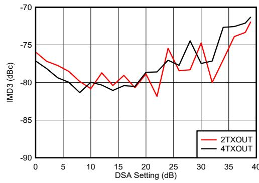
$f_{\text{DAC}} = 11796.48\text{MSPS}$ 、インターリープモード、4.9GHz で整合、 $f_{\text{CENTER}} = 4.9\text{GHz}$ 、各トーン -13dBFS
