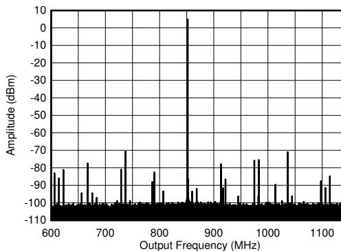
$f_{\text{DAC}} = 5898.24\text{MSPS}$ 、ストレートモード、0.8GHz 整合あり、PCB とケーブルの損失を含む
