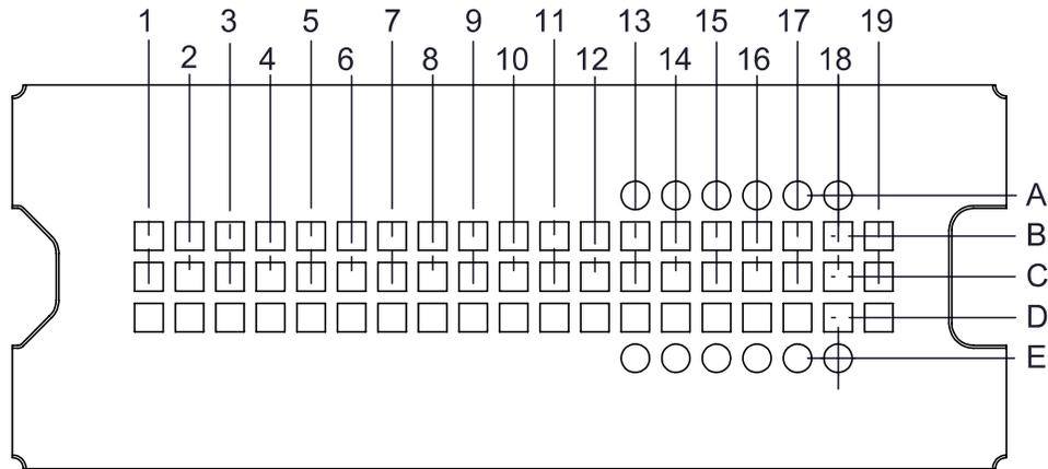
图 5-1. FQK Package 57-Pin LGA (Bottom View)
