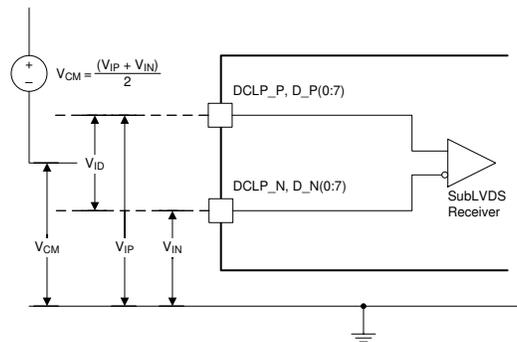
**图 6-9. SubLVDS Voltage Parameters**
