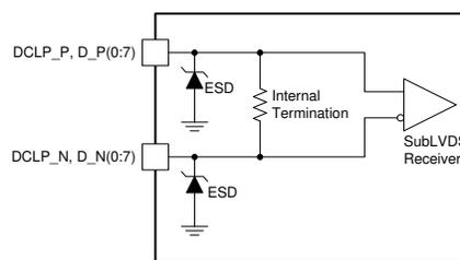
**图 6-11. SubLVDS Equivalent Input Circuit**
