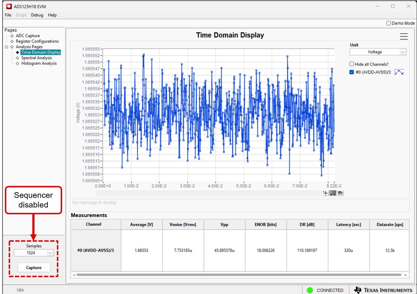
图 4-8. ADS125H18 EVM GUI 时域页面 — 序列发生器已禁用
