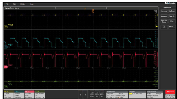
图 3-37. Vin = 264Vac , Vout = 12V
