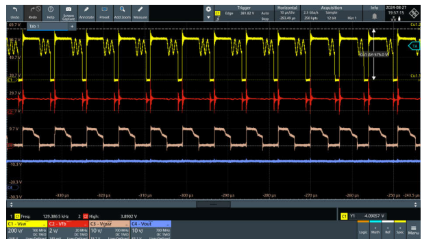
图 3-21. Vin = 264Vac , Vout = 15V
