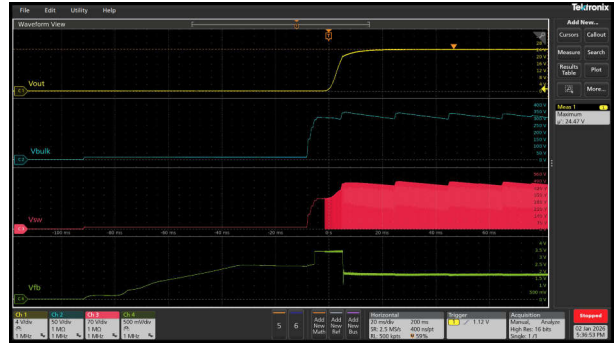
图 3-11. 满负载条件下 24V 输出的启动波形
