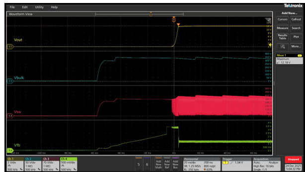
图 3-13. 满负载条件下 12V 输出的启动波形
