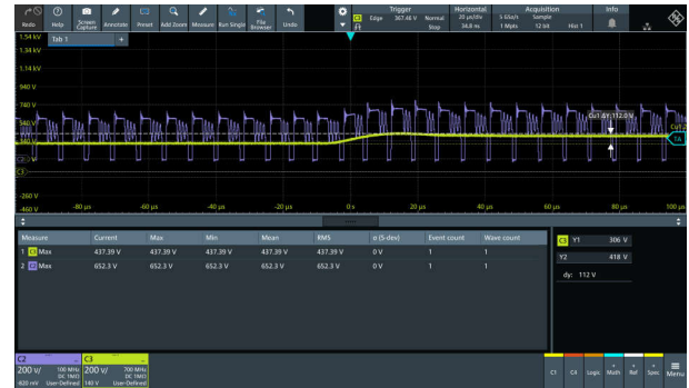
图 3-65. 230Vac 输入电压时的 1KV 浪涌
