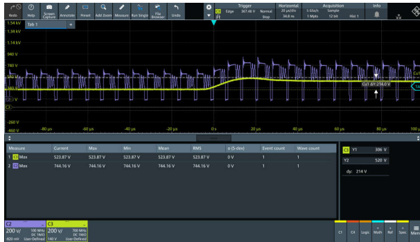
图 3-64. 230Vac 输入电压时的 2KV 浪涌
