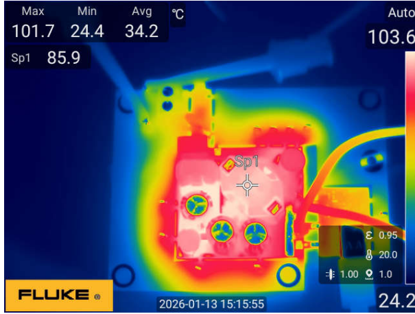
图 3-70. V_{IN} = 90V_{AC} ，顶面
