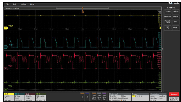
图 3-33. Vin = 264Vac , Vout = 24V
