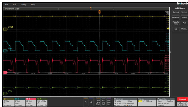
图 3-36. Vin = 230Vac , Vout = 12V
