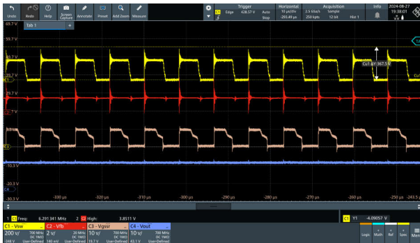
图 3-18. Vin = 90Vac , Vout = 15V
