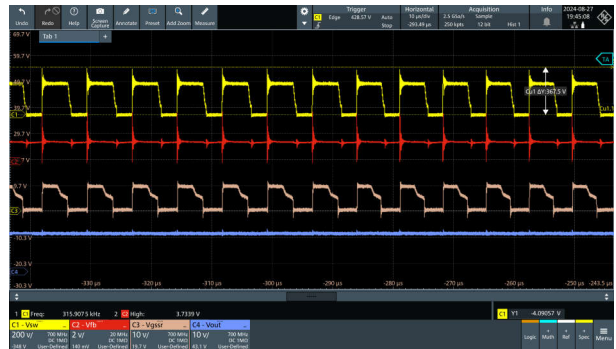
图 3-19. Vin = 115Vac , Vout = 15V
