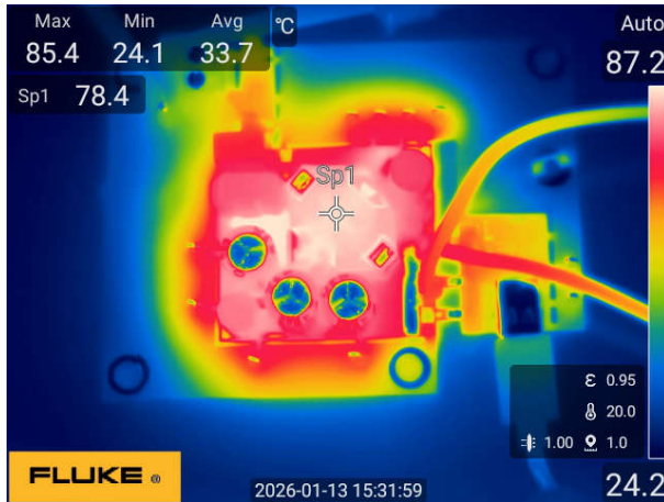
图 3-72. V_{IN} = 115V_{AC} ，顶面
