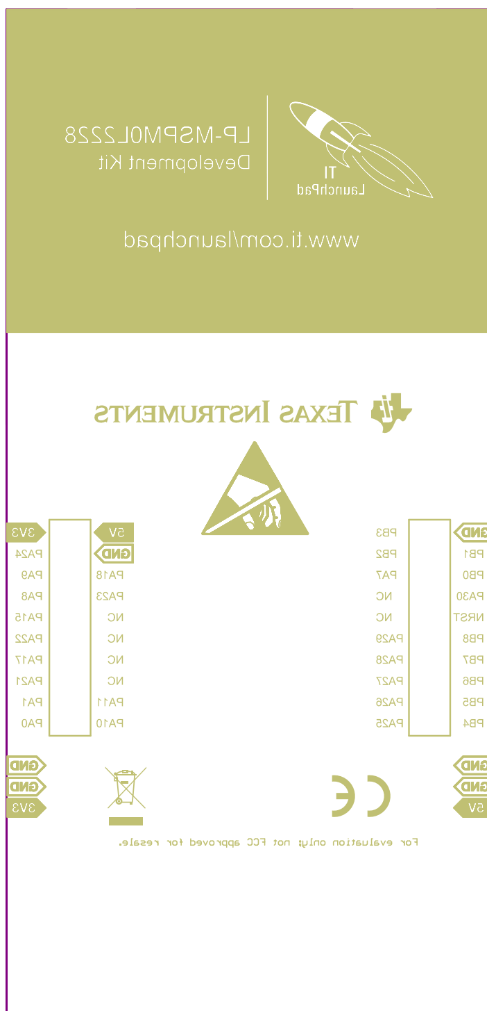
图 4-11. PCB 底部覆盖层
