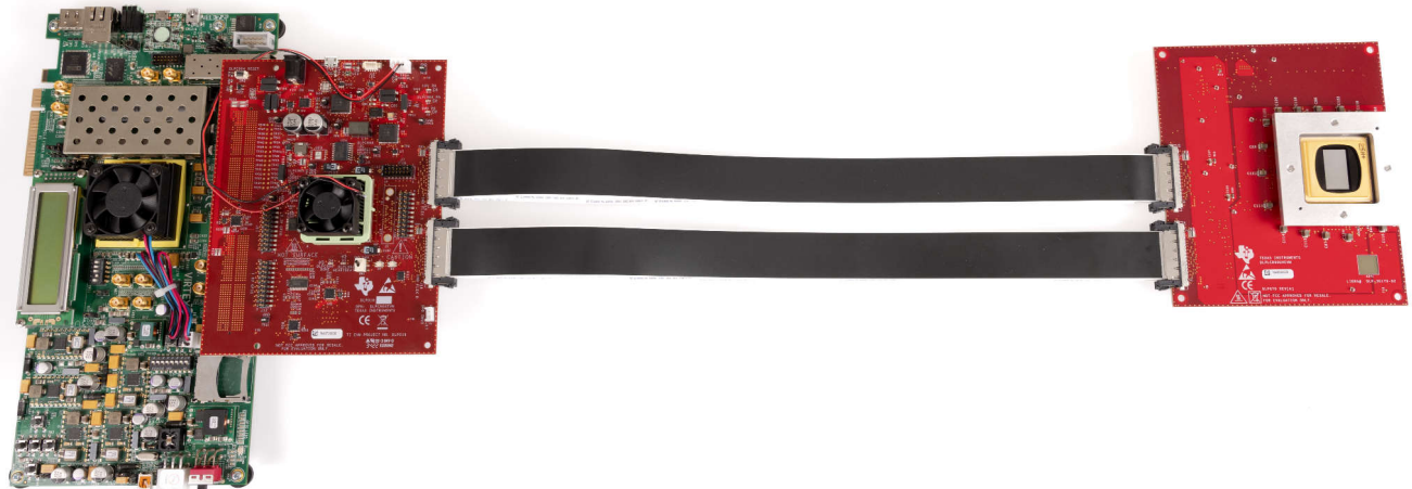
图 2-6. 带 AMD EVM 的完全组装 DLPLCRC964EVM
