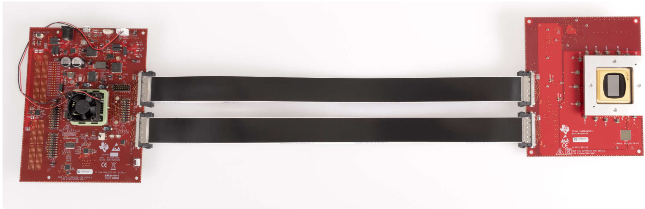
图 2-3. 独立 DLPLCRC964EVM 和 DLPLCR99EVM/DLPLCR99UVEVM
