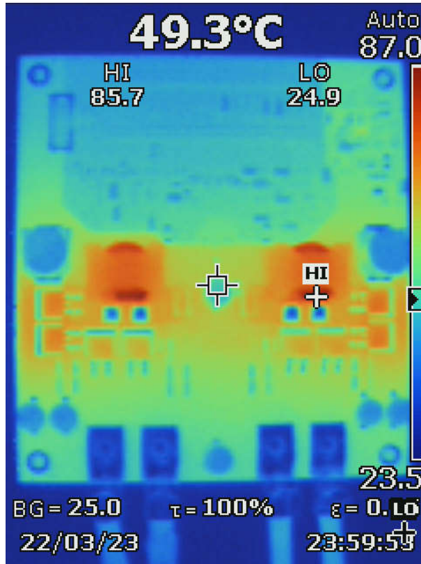
图 4-3. 热像图：降压模式， V_{in} = 48V ， V_{OUT} = 14.5V ， I_{OUT} = 60A ，对流
