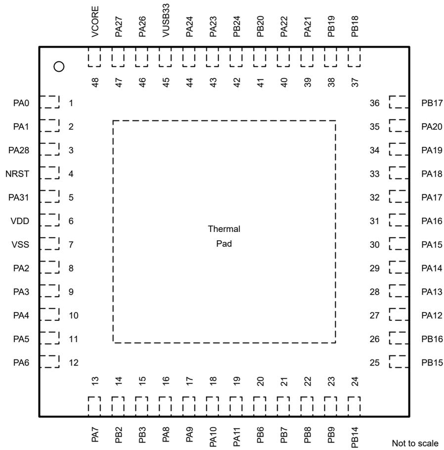
图 6-3. 48 引脚 RGZ (0.5mm) (VQFN) 封装图
