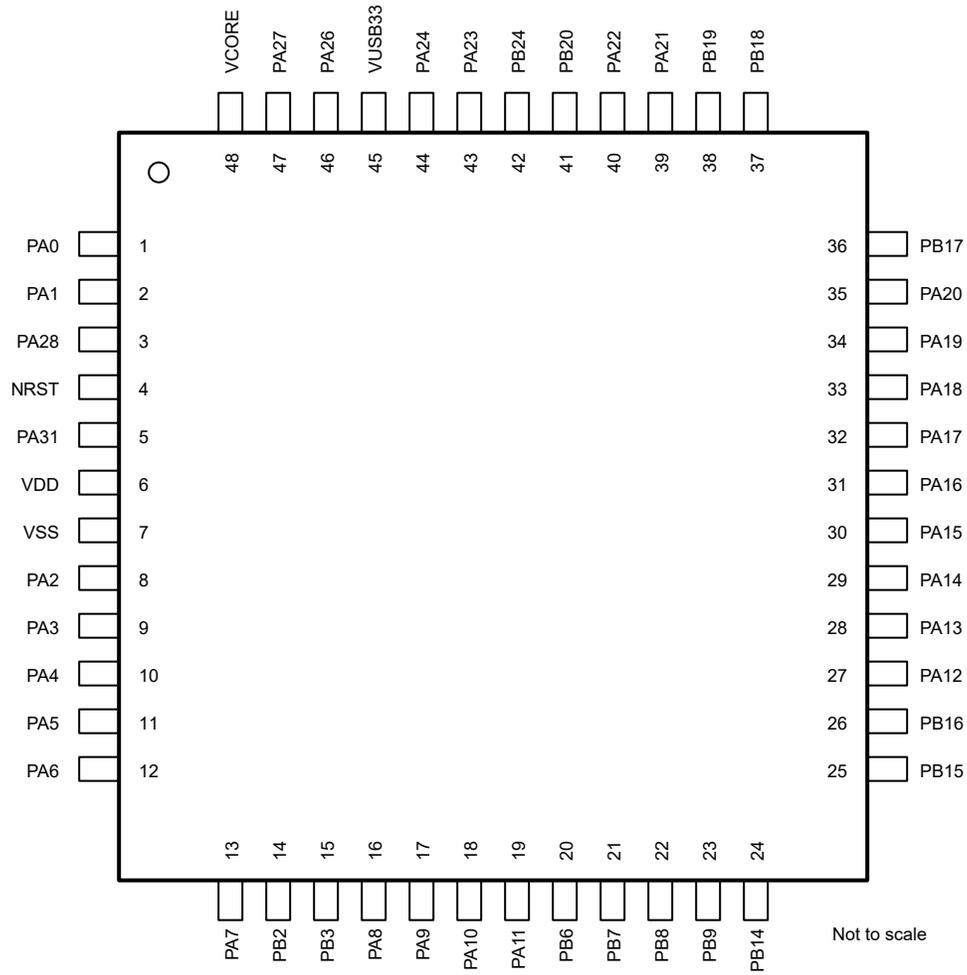
图 6-2. 48 引脚 PT (0.5mm) (LQFP) 封装图
