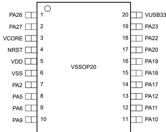
图 6-8. 20 引脚 DGS (0.5mm) (VSSOP) 封装图
