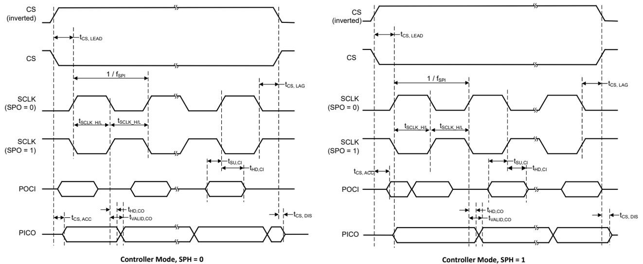
图 7-4. SPI 时序图 - 控制器模式
