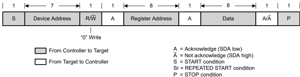
图 7-22. 标准模式、快速模式和快速+ 模式下的写入数据传输格式
