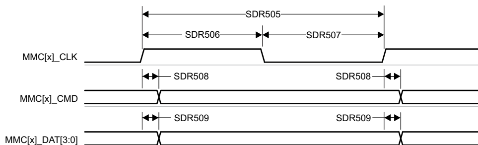
图 6-97. MMC1 - UHS-I SDR50 - 发送模式
