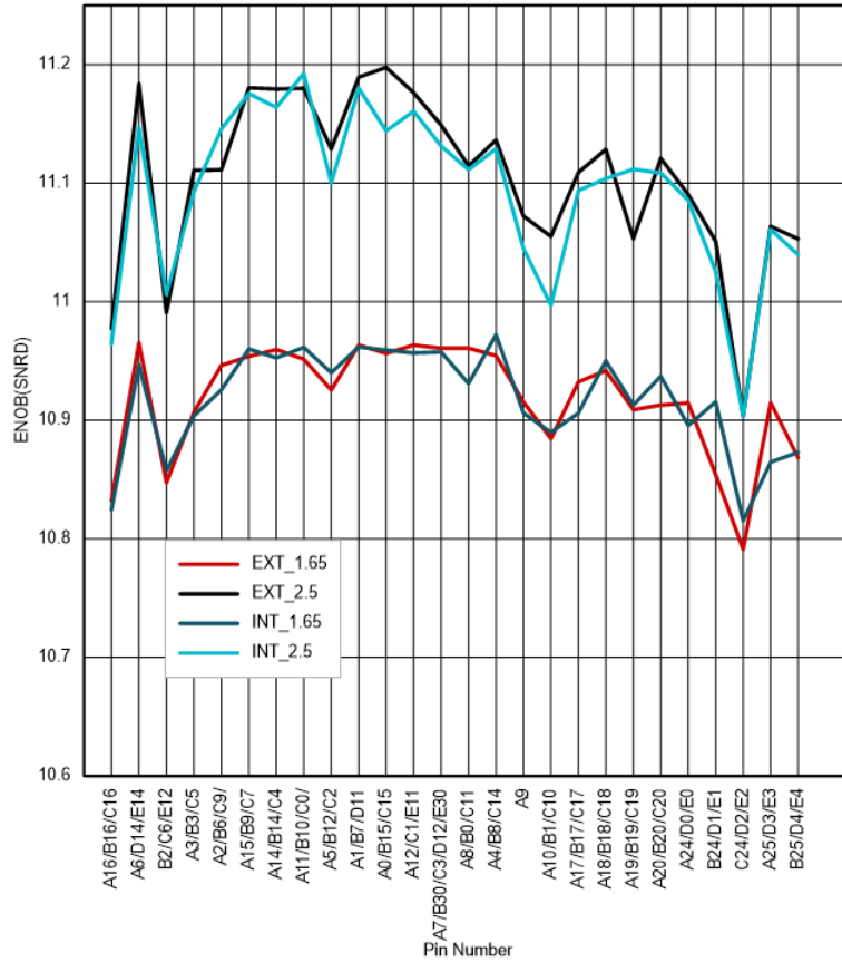
图 6-41. 64 引脚 PM 的每通道 ENOB
