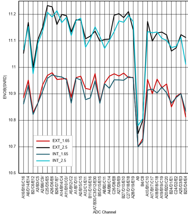
图 6-38. 128 引脚 PDT 的每通道 ENOB
