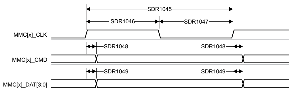
图 6-87. MMC1/MMC2 - UHS-I SDR104 - 发送模式
