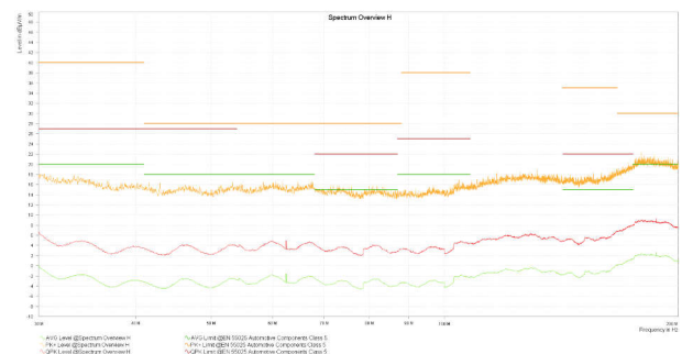
图 8-29. 辐射 EMI 单极与 CISPR25 限值，LMR60440QEV
