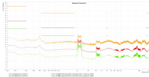
图 8-28. 传导 EMI 与 CISPR25 限值 (紫色：峰值信号，绿色：平均信号)，LMR60440QEVm
