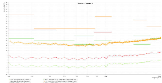
图 8-29. 传导 EMI 与 CISPR25 限值 (紫色：峰值信号，绿色：平均信号)，LMR60440QEVm
