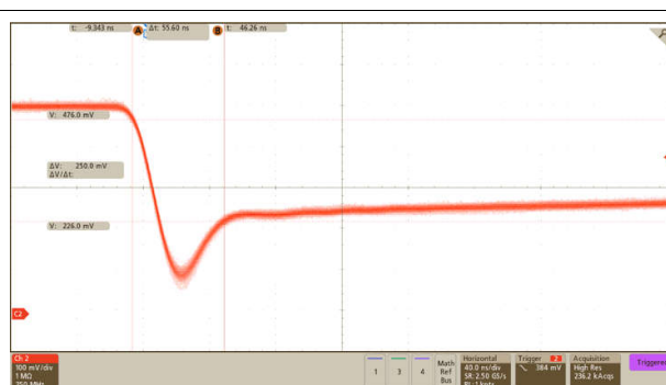
图 7-9. 100 \mu A 至 10 \mu A 电流阶跃
