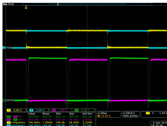
图 8-5. INA/B 和 OUTA/B 的台架测试波形
