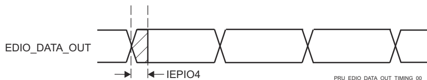
图 6-101. PRU_ICSSG IEP 数字 IO 时序要求
