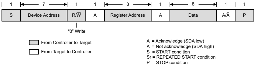
图 8-21. : 标准-、快速和快速+ 模式下的“写入”数据传输格式
