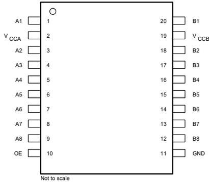
图 4-1. DGS/PW 封装 (顶视图)
