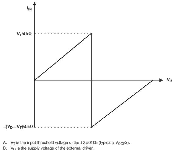
图 7-2. 典型  $I_{IN}$  与  $V_{IN}$  曲线
