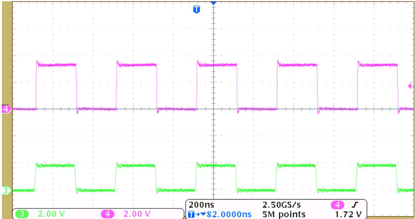
图 8-2. 2.5MHz 信号的电平转换
