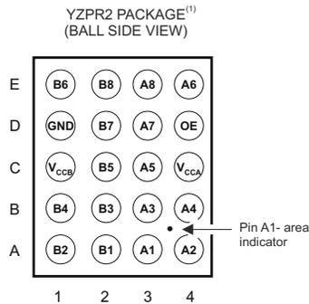
图 4-5. YZPR2 封装 (焊球侧视图)
