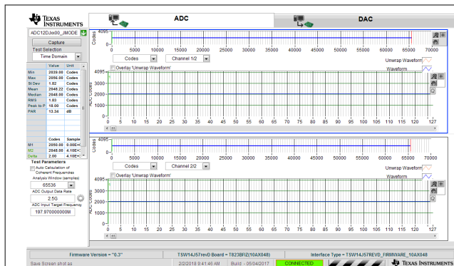
图 8-10. 2.5GSPS 双通道示波器的空闲通道噪声 (无输入)
