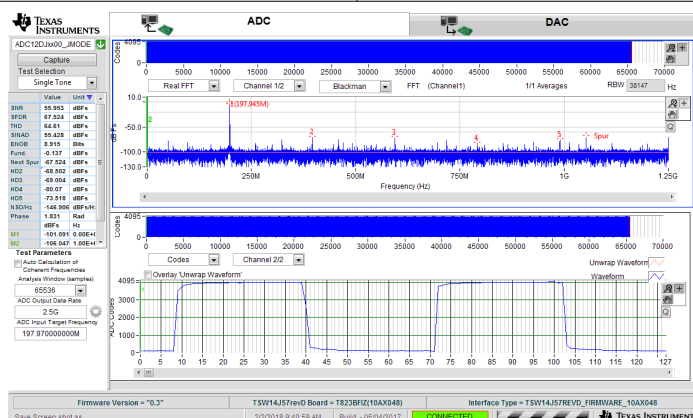
图 8-12. 5GSPS 单通道示波器的 200MHz 正弦波 (通道 A) 频域 (FFT) 和 40MHz 方波 (通道 B) 时域
