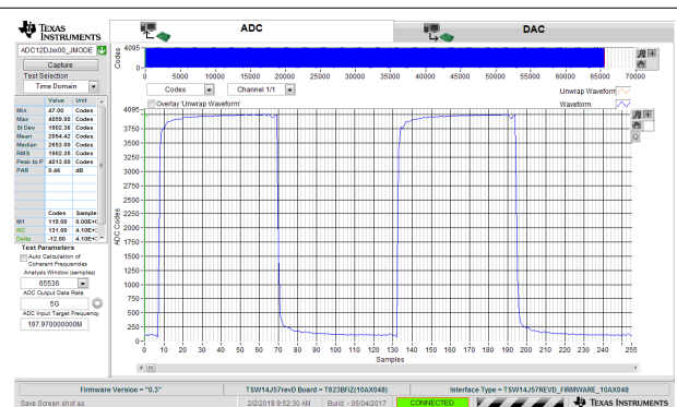
图 8-7. 5GSPS 单通道示波器的 40MHz 方波时域
