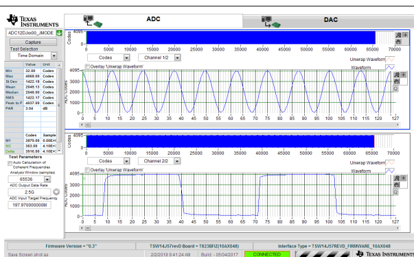
图 8-11. 5GSPS 单通道示波器的 200MHz 正弦波 (通道 A) 和 40MHz 方波 (通道 B) 时域
