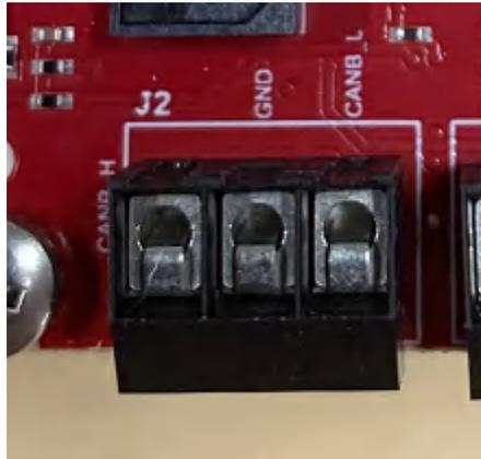
**Figure 2-11. CAN\_B Connector**
