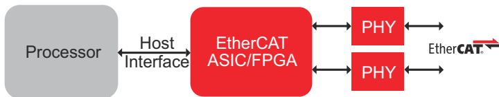
图 5. 采用 ASIC 和外部处理器的 EtherCAT。
