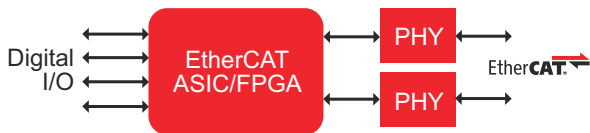
图 4. 基本数字 I/O EtherCAT 器件。
