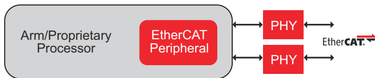
图 6. 将 EtherCAT 与处理器集成。
