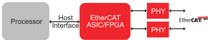
图 5. 采用 ASIC 和外部处理器的 EtherCAT。
