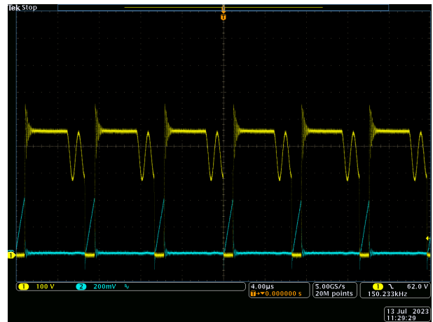
图 3-16. Vin = 265Vac , Vout = 15V
