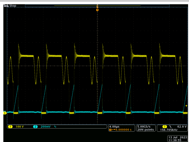
图 3-12. Vin = 265Vac , Vout = 20V
