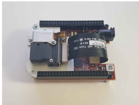
图 1-2. DLP 模块 2000 EVM (安装在 DLPDLR2000EVM 上, 不包含在 DLPM2000EVM 中)
