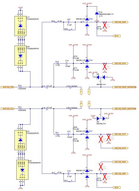
图 3. ECG Subcircuit - Leads
