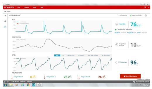
图 29. GUI Showing the Pacemaker Detection
